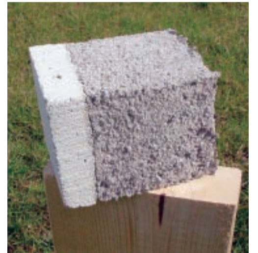
Abb. 8, 9: Aufgespritzte Zellulosedämmung, herausgetrennte Prüfkörper. Fotos: Michael Mandel (4)
