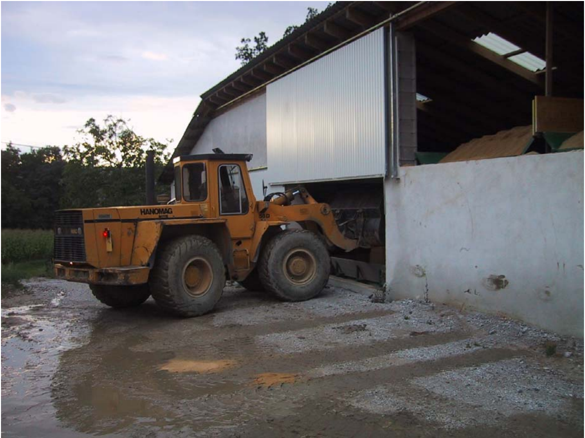
Bild D: Beschickung der Mischanlage des n&l Werks Winzing. Biofaserlehm-Herstellung mit Faserdosierung.
