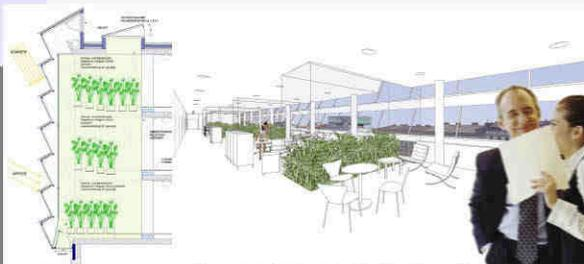
Großraum Süd mit Grünpuffer für Luftfeuchte konditionierung
