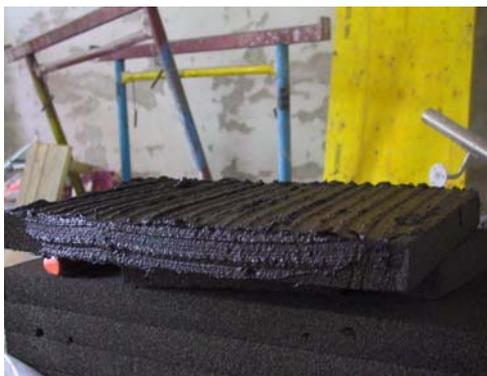
Die Vorteile liegen in der relativ einfachen Verarbeitung. Die Verklebung (auch an den Stößen) muss mit einem Dispersions- oder Bitumenkleber erfolgen (Ausdampfung erfolgt nur während der Verarbeitung). Für die Endbeschichtung darf ausschließlich Dispersionsputz zum Einsatz kommen, da Schaumglas keinen Zement verträgt.
