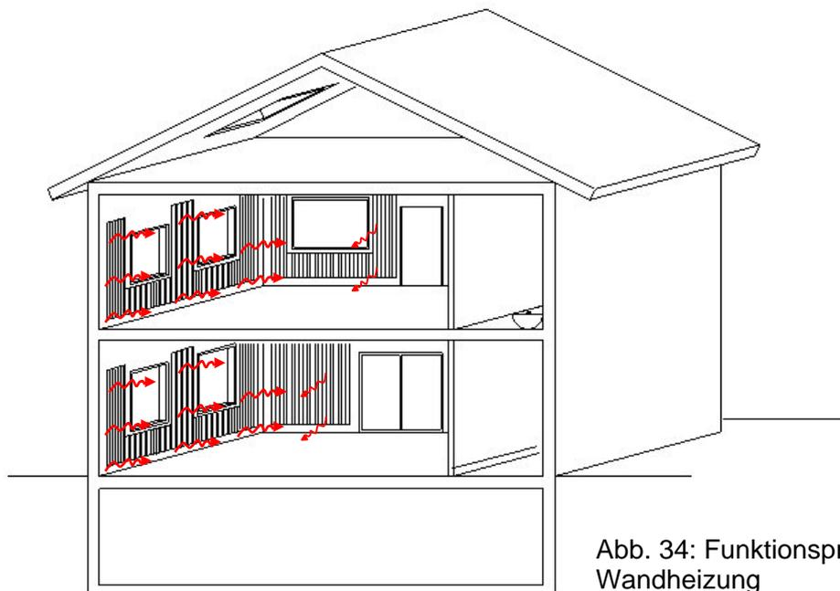
Abb. 34: Funktionsprinzip einer Wandheizung
