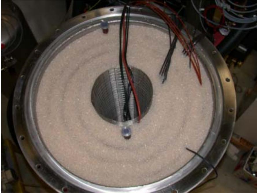
Abb. 6: Blick von oben in den Sorptionsspeicher der zweiten Generation (Dampfkanal in der Mitte und Spiralwärmetauscher mit Silikagel gefüllt)
