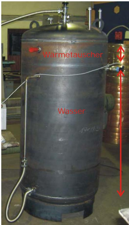
Abb. 9: Der Wasservorratsbehälter
