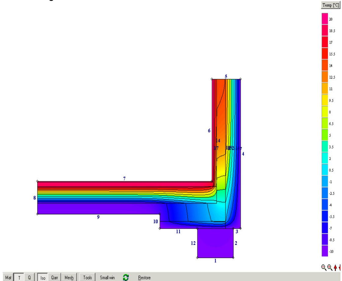
**10 cm, 80 cm breit**Sum( $q_{in}$ )= 27.699 W/m Iter:4421Sum( $q_{in}-q_{out}$ )= 0.0001 W/m**16 cm, 80 cm breit**Sum( $q_{in}$ )= 27.568 W/m Iter:4204Sum( $q_{in}-q_{out}$ )= -0.002 W/m**10 cm ; 110 cm breit**Sum( $q_{in}$ )= 25.949 W/m Iter:5133Sum( $q_{in}-q_{out}$ )=-0.0002 W/m**Wärmeverluste über Bruttomaße**
