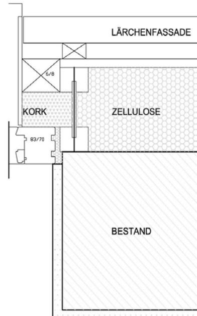
Abbildung 8: Überdämmung der Fensterrahmen, Projekt Fa. Nordpool Steyr (Quelle: Architekten Poppe & Prehal)
