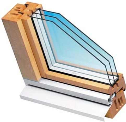
Im Falle dieses Holzfensters wurde durch Anordnung von verschiedenen Luftkammern im Fensterrahmen der Wärmedurchgang reduziert. Für das Gesamtfenster wurde dadurch im Prüfstand ein U-Wert von  $0,79 \text{ W/m}^2\text{K}$  erreicht.
