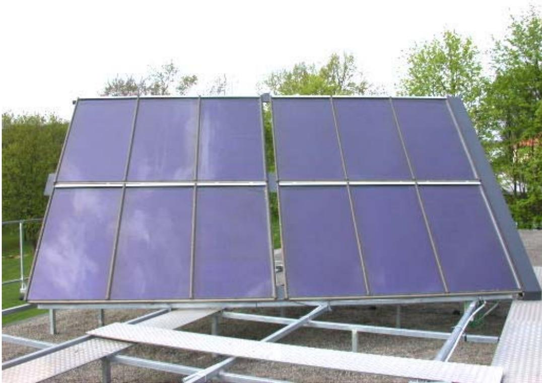
Abbildung 65: Ansicht der Versuchsanordnung – zweite Messperiode – 4 Testkollektoren, am Beispiel der Verschaltungsvariante Serpentine, hoch-2S, 2P dargestellt.
