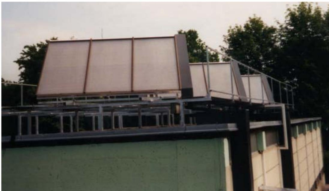
Abbildung 4: Anordnung der drei Flachkollektoren aus der ersten Messserie am Versuchsstand der AEE INTEC - Südansicht
