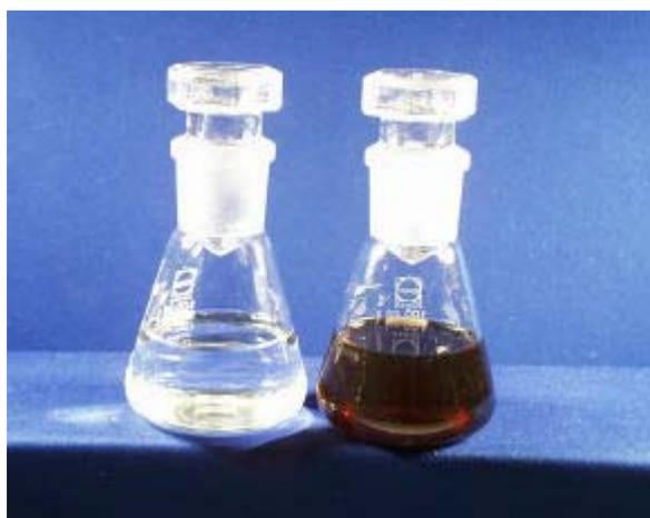
Abbildung 108: Gealtertes Standard-Fluid (pH-Wert 6,8, rechts.) im Vergleich zum Ausgangszustand (pH-Wert 8,2)
