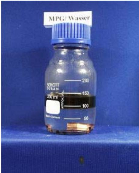
Abbildung 110: MPG/H<sub>2</sub>O 50 % bei 300 °C, 43 h
