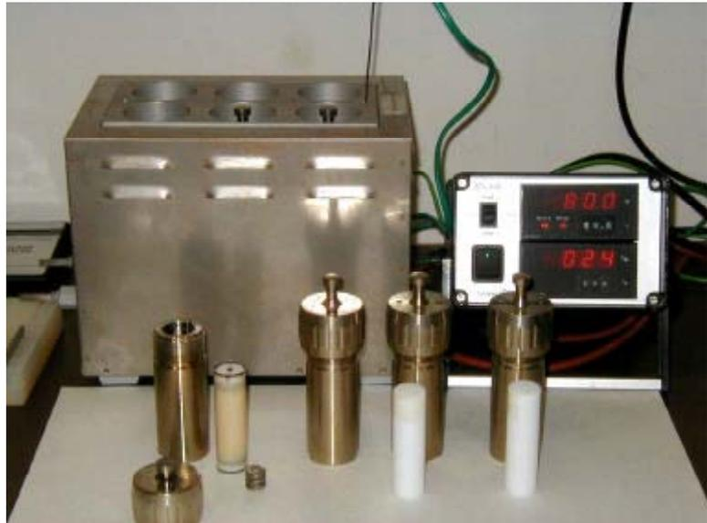
Abbildung 111: Aufbau Autoklaventest TYFOROP / Belastung bis 235 °C
