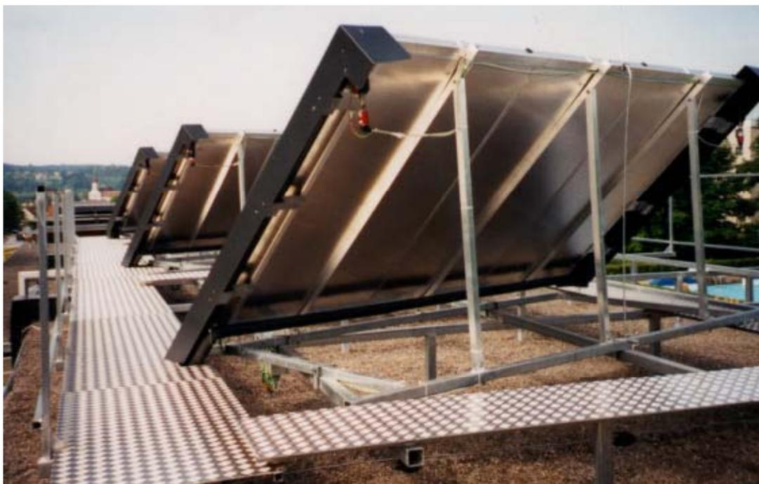
Abbildung 5: Anordnung der drei Flachkollektoren aus der ersten Messserie am Versuchsstand der AEE INTEC – Nordansicht.
