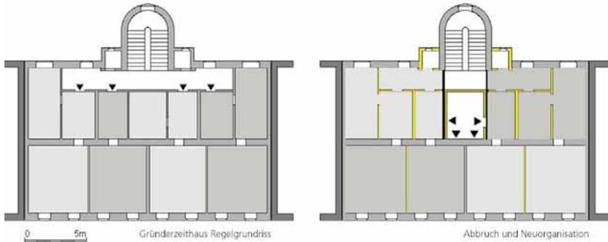
Oberhalb des letzten Geschosses schlagen wir einen kompletten Neubau vor. Der Dachstuhl samt Feuermauern soll abgetragen werden, ebenso das Kaminmauerwerk der Mittelmauer.
