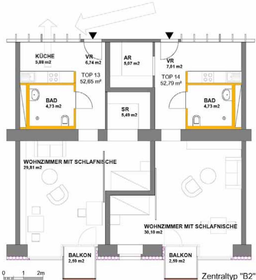
In allen Fällen A und B ist es wichtig, die öffentliche Gangzone (siehe Kap. 6.5.4) auszuweiten und zu einer Aufenthaltszone umzubauen, um die gangseitigen Räume (insbesondere die Küche) aufzuwerten. Im öffentlichen Flur können die Mauerpfeiler der Außenwand in Teilen durch Schleuderbeton stützen ersetzt werden, um den positiven Aspekt der Gartenzone in die Grundrisse zu tragen.
