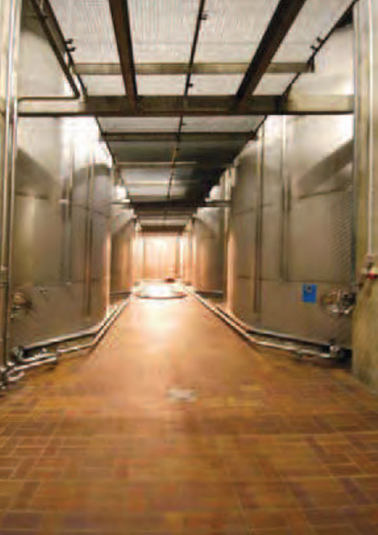
▲ Abbildung 1 Kellerei Possmann, ein Edelstahlbehälter wird nach Auslieferung des Apfelweins temporär für die Zwischenspeicherung von Regenwasser verwendet (Speicher mit blauem Schild)
