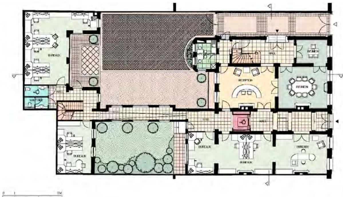
**Abbildung 15** REH Brüssel, Hausnummern 63-65 – Grundriss des Erdgeschosses inkl. Verbindungsgang und Hofgebäude nach der Sanierung (Quelle: EREC)
