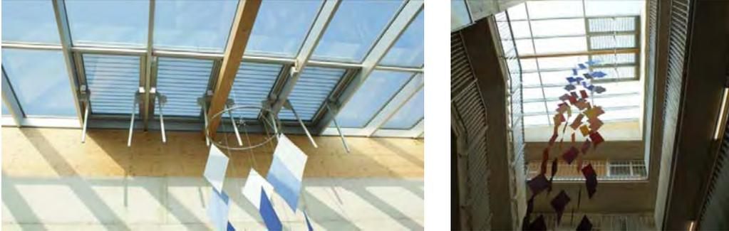
Abbildung 6: links: Schwerkraftentlüftung am höchsten Punkt des Gebäudes, rechts: Atrium des Gebäudes SOL4 [AEE INTEC]
