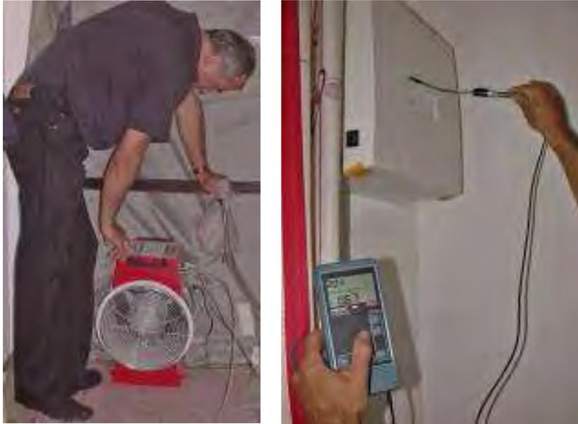
**Abbildung 15** Messung der Luftdichtheit der Wände während der Bauphase (links). Luftundichtheiten können z.B. mit Hilfe von Rauch oder Anemometermessungen festgestellt werden (rechts) (Quelle: AEE INTEC).
