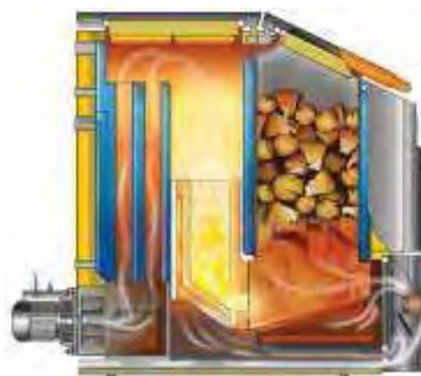
Abbildung 18: Wandheizung (=Niedertemperaturheizungssystem) und neueste Heizkesseltechnologie, rechts ist ein Scheitholzkessel dargestellt, erhöhen den Jahresnutzungsgrad des Heizungssystems (Quellen: natürlich bauen GmbH, Guntamatic)
