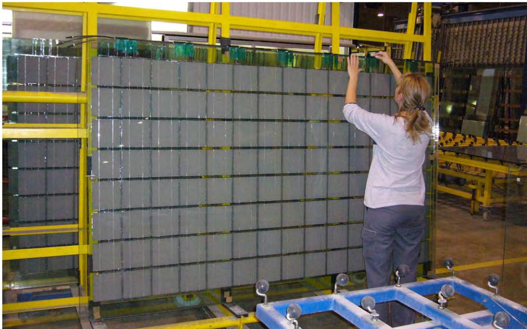
Die fassadenintegrierte Photovoltaikanlage von Ertex Solar hat eine Leistung von ca. 6 kWp und wird ca. 4800 kWh jährlich eintragen.
