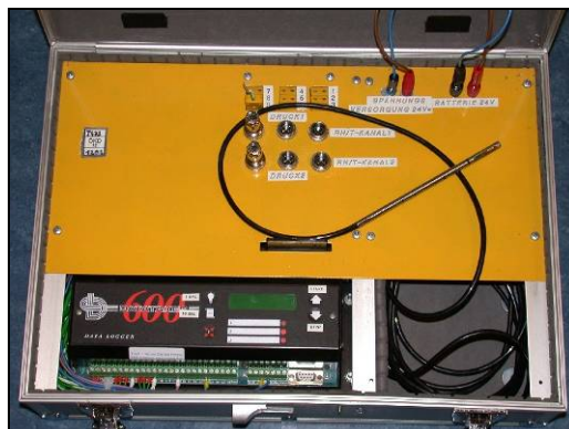
Abbildung 0.1: Messkoffer mit Anschlüssen der Messaufnehmer
