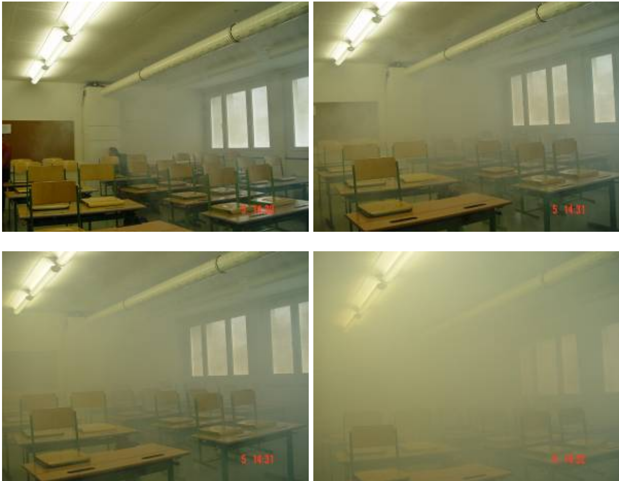
Abbildung 6.19 a–d: Raumdurchströmung in der Klasse 3a
