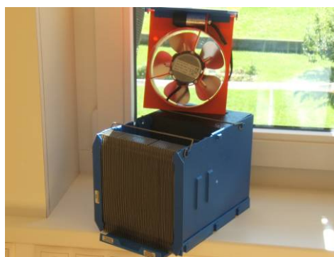
Abbildung 73: Lüftungsgerät (Innenleben LTM)
