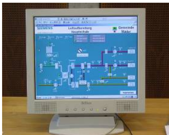
Abbildung 9.48 a und b: Visualisierungen für zentrale Lüftungsanlage
