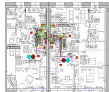
Haus 1 (Haus 3) Lüftungsschema, Grundriss
