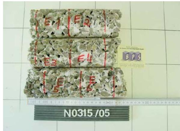
Prüfkörper der Kernbohrungen
