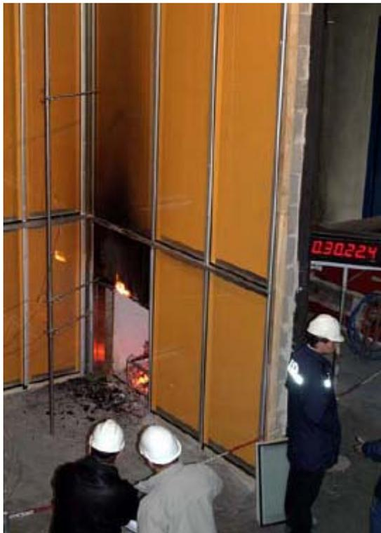
Die Prüfdauer beträgt mindestens 30 Minuten. Ein wesentliches Kriterium für eine positive Beurteilung ist, dass keine großen Plattenteile  $> 0,4 \text{ m}^2$  oder mit Massen  $> 5 \text{ kg}$  herabfallen.
