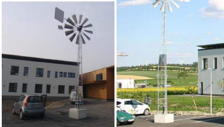
Abbildung 35: anfänglicher und fertiger Langsamläufer
