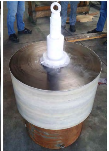
Abbildung 3.3.5: Aufschumpfen der CFK-Schwungmasse auf die Welle (aus [Sima_2014a]).
