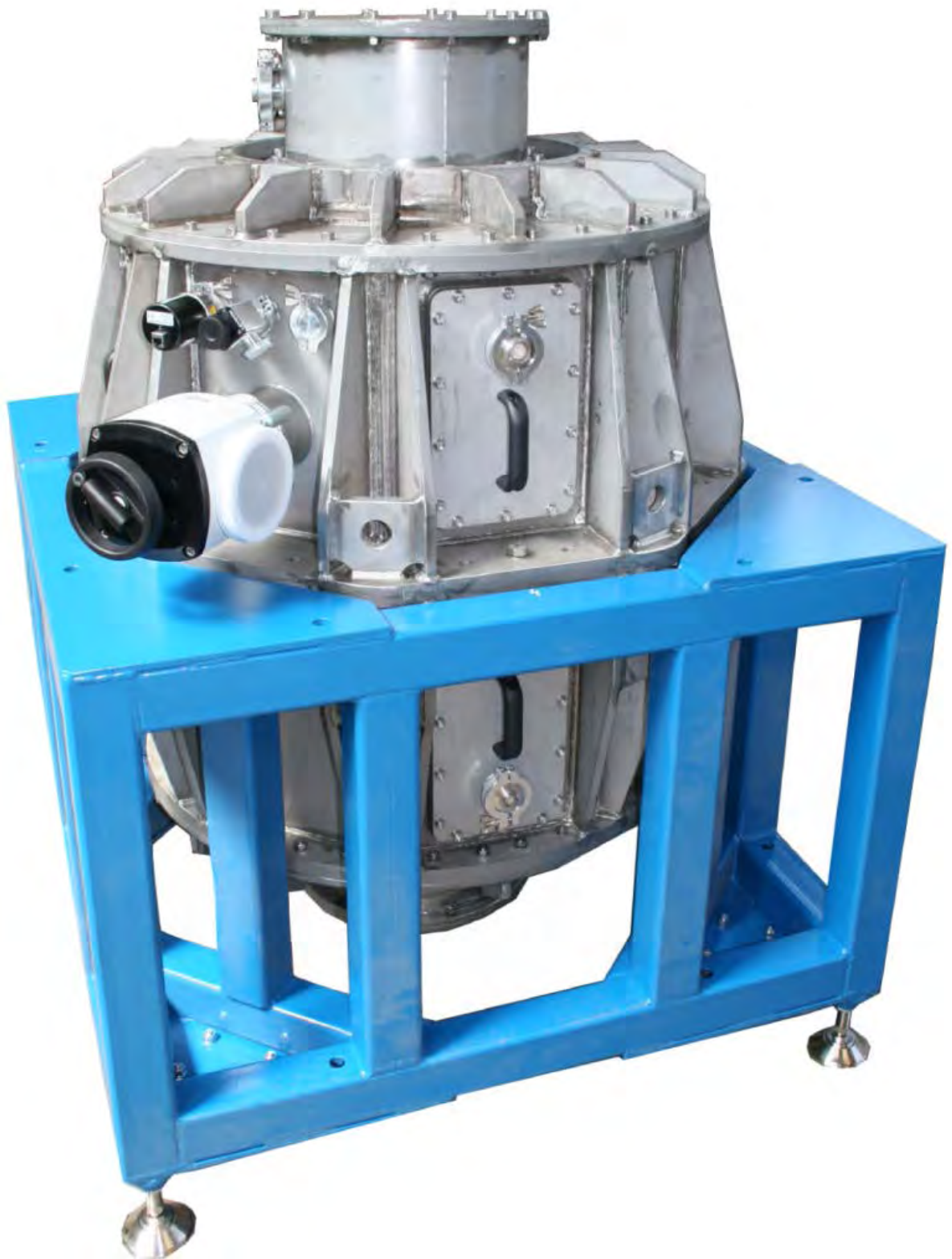
Abbildung 3.5.8: Komplett assemblierter Schwungradspeicher Messaufbau.
