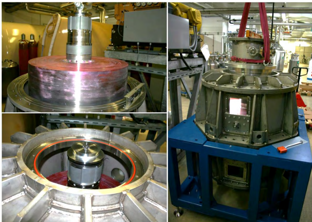
Abbildung 3.5.7: Zusammenbau des Schwungradspeichers.
