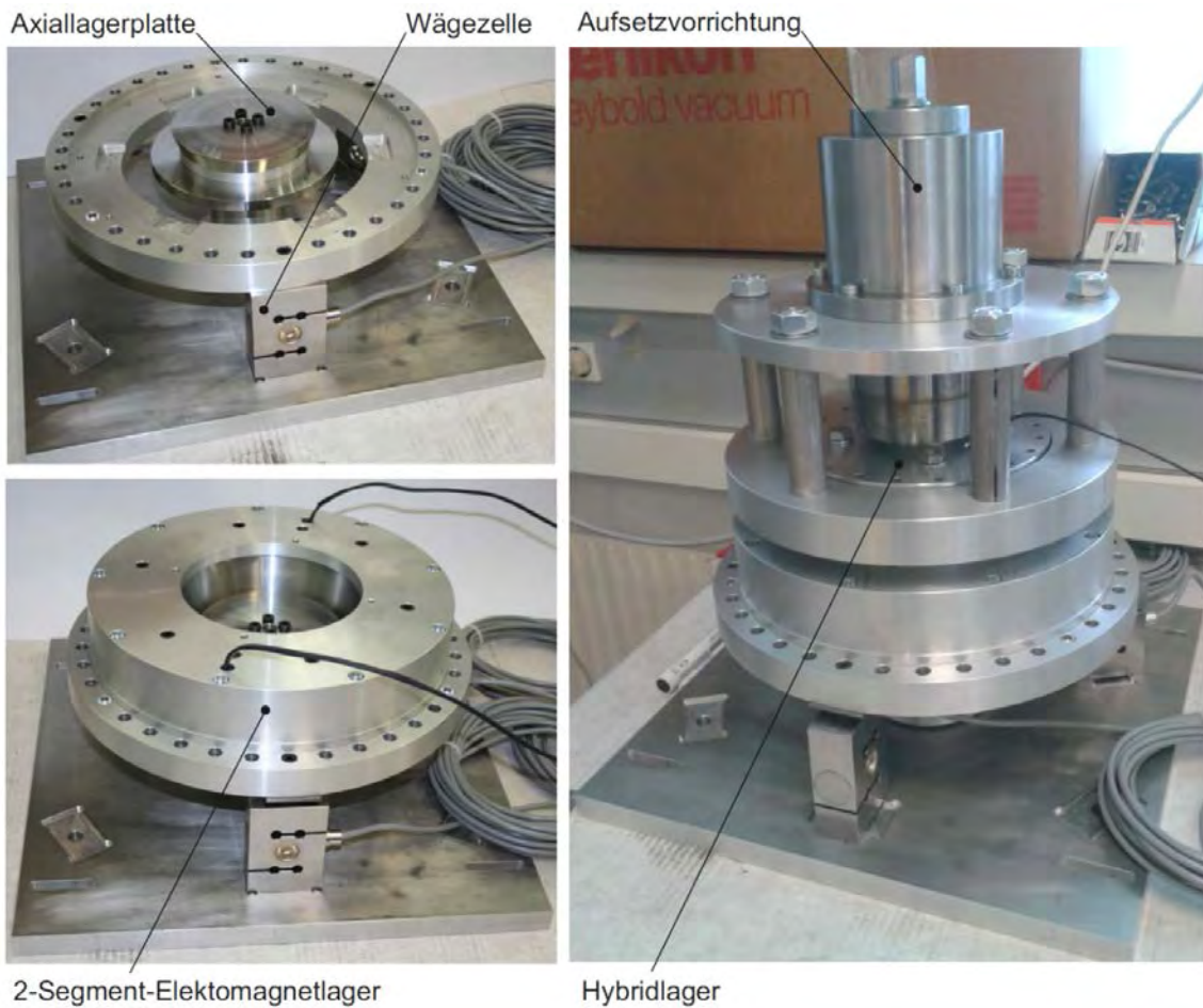
Abbildung 3.2.25: Axiallagerprüfstand zur Validierung der Magnetlagerkennlinien (aus [Sima_2014a]).
