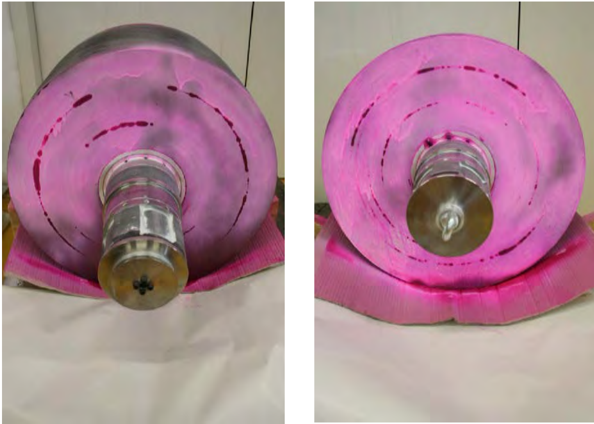
Abbildung 3.3.6: Risse in der CFK-Schwungmasse (aus [Sima_2014a]).
