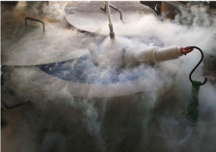
Abbildung 3.3.5: Aufschumpfen der CFK-Schwungmasse auf die Welle (aus [Sima_2014a]).
