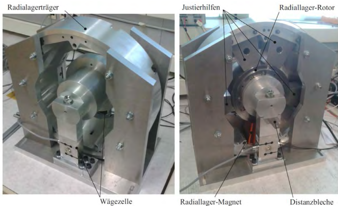
Abbildung 3.2.26: Radiallagerprüfstand zur Validierung der Magnetlagerkennlinien (aus [Sima_2014a]).
