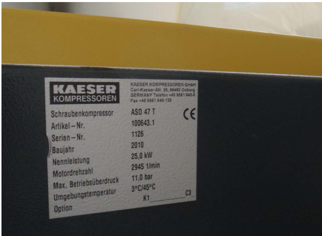
Abbildung 14: Typenschild des Kompressors (neu) KAESER ASD 47 T
