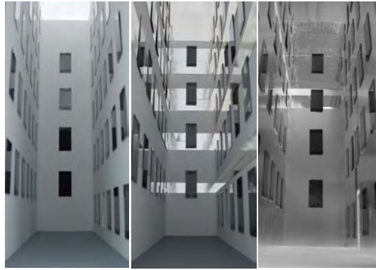
Abbildung 9: Innenhof mit lichtlenkenden Oberflächen: 1. diffuse Oberfläche (saniert), 2. Lichtlenkung mit hochglänzendem Alu, 3. Lichtlenkung mit hochglänzendem und satiniertem Alu.
