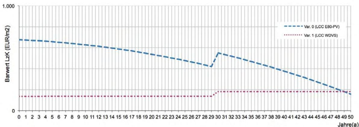
Abbildung 56: Gegenüberstellung der LCC für e80<sup>3</sup> PV und WDVS Standardausführung – Szenario: Energiepreissteigerung (Quelle: IMBT TU Graz)
