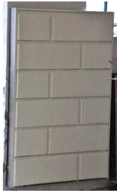
Abb.10: Kalorimeter-Messmodul 3– geschlossen – Design Feinputz
