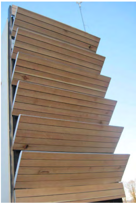
Abb.9: Kalorimeter-Messmodul 2 im Einsatz – teilgeöffnet – Design Holz
