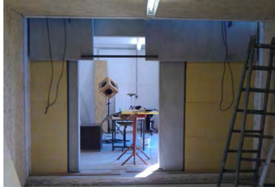
Abbildung 37: Links: Darstellung der zweischaligen Stahlbetonwand für den Einbau von Zimmertüren. Rechts: Foto beim Einheben einer Stahlbetonwand mit Prüfoffnung
