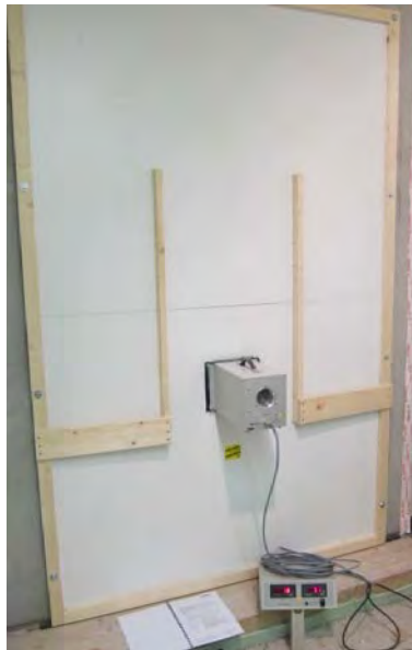
Abbildung 38: Messaufbau zur Bestimmung des Strömungswiderstandes. Entnommen aus (Rojas, Rothbacher, & Pfluger, 2012).
