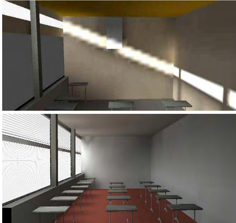
Abbildung 29 Beispiel einer Tageslichtsimulation - oben IST-Situation, unten SOLL-Situation (Quelle: BVST J. Gerstmann)
