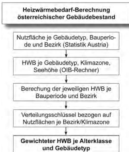
Abbildung 6 Ablauf – Heizwärmebedarfsberechnung (Schulter, 2012)
