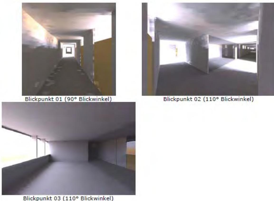
**Abbildung 51: Beispiel-Rendering als Ergebnis der Tageslichtsimulation – Wirkung der „Lichtfallen“ (Quelle: hecht licht- und elektroplanung)**
