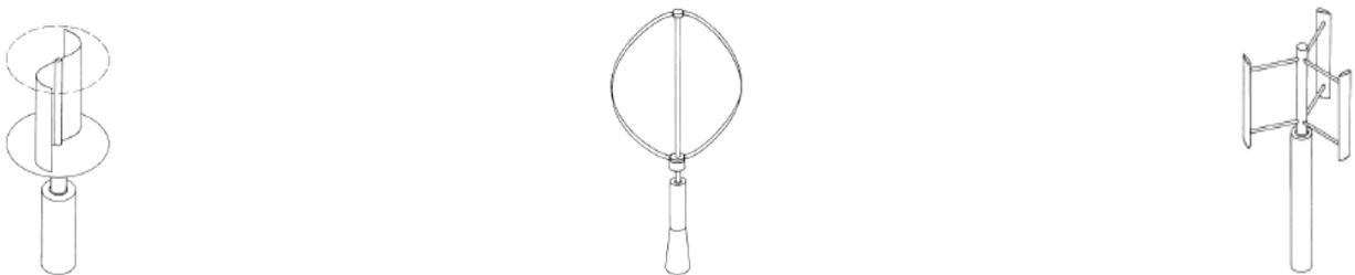
**Abbildung 78:** Rotoren um die vertikale Achse, links: Savoniusrotor, mittig: klassischer Darrieus-Rotor, rechts: Darrieus-H-Rotor (Halbhuber, 2009)
