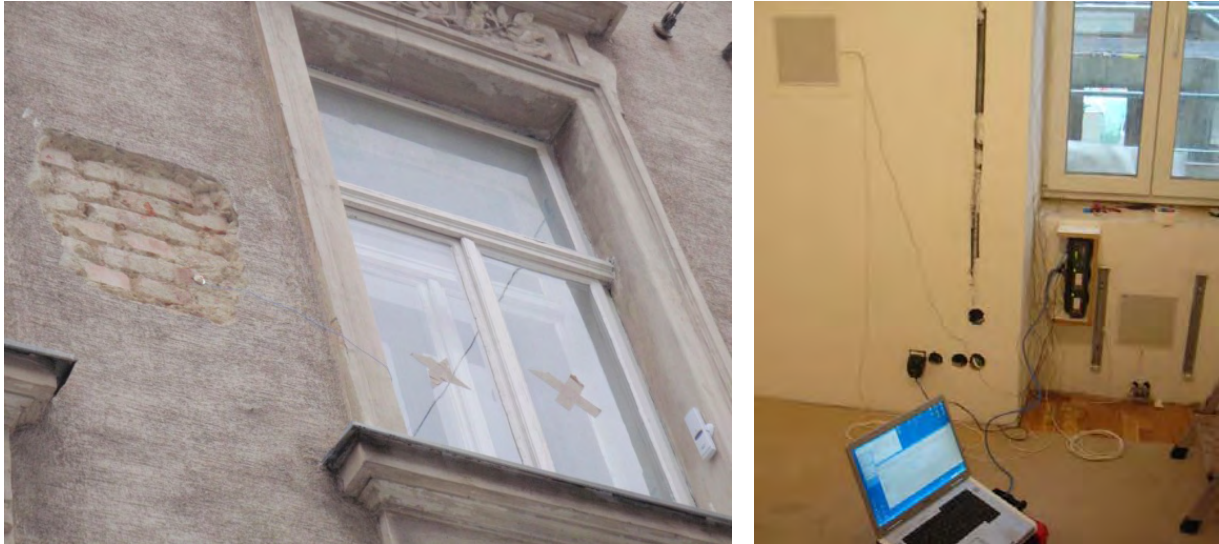
Abbildung 6: U-Wert Messung TU Wien (Fotos: Gassner, e7)
