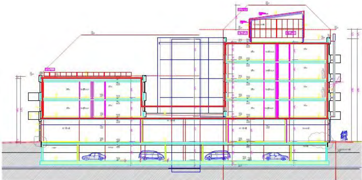
Abbildung 2.2: Im rot markierten Bereich wird die Solarfassade angenommen [Tru10];
