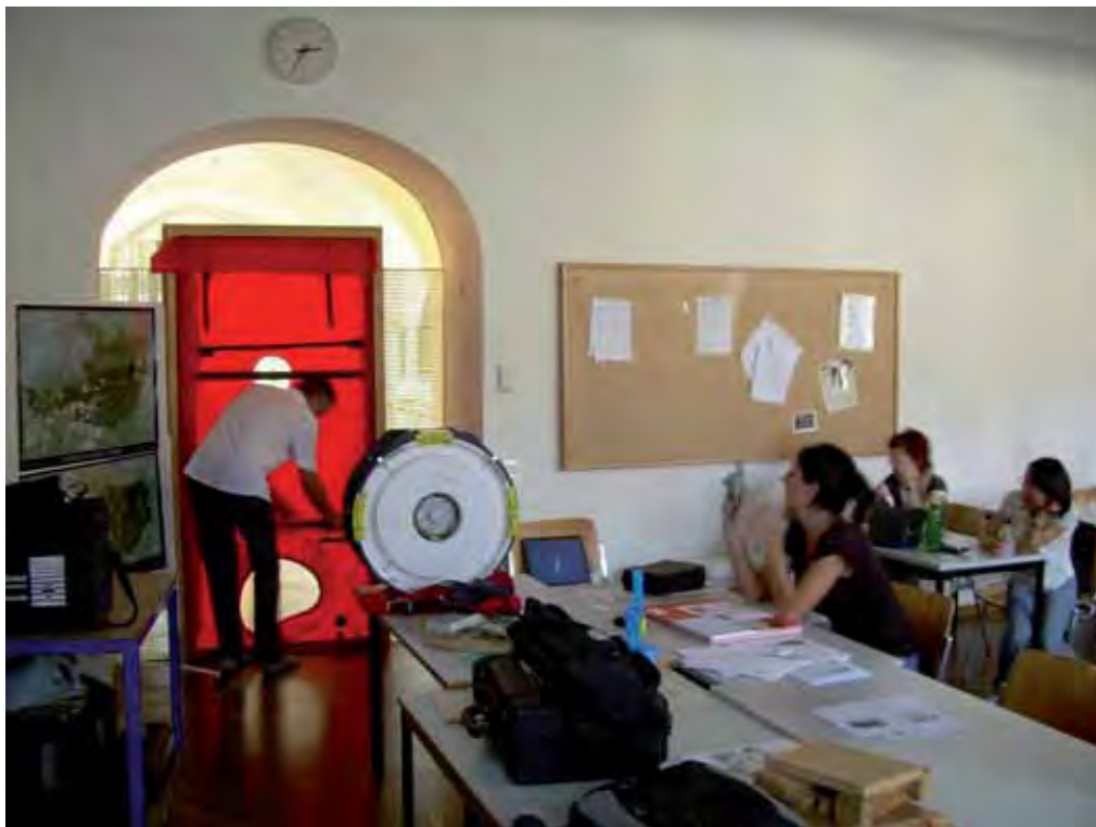
Abb. 24: Demonstration einer Druckdifferenzmessung (Blower door)
