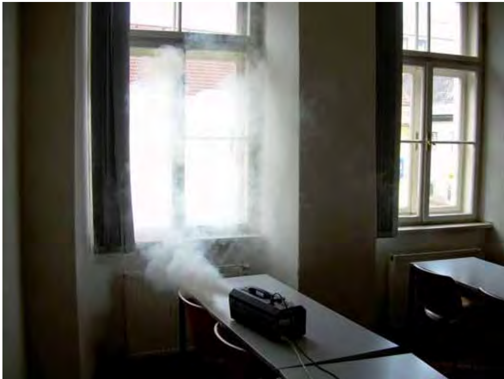
Abb. 25: Demonstration einer Kaltrauchmaschine
