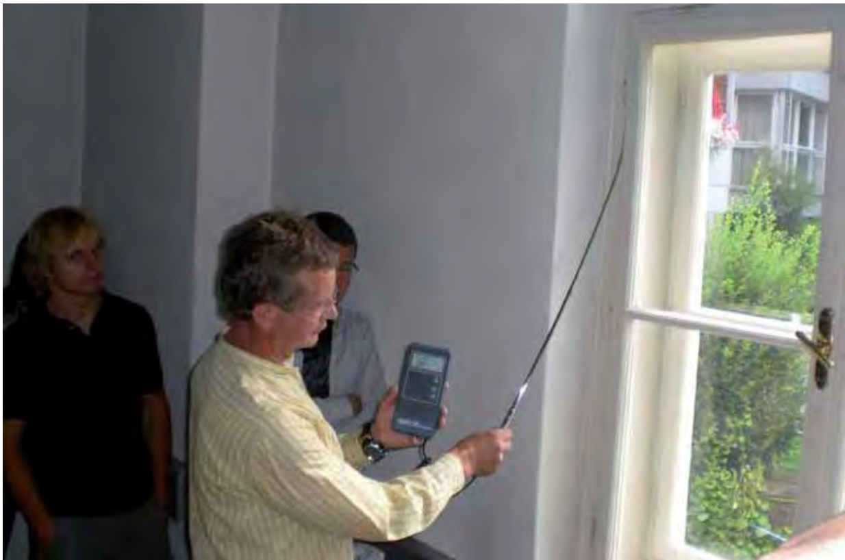
Abb. 20: Messung der Durchströmung von Fensterfugen
