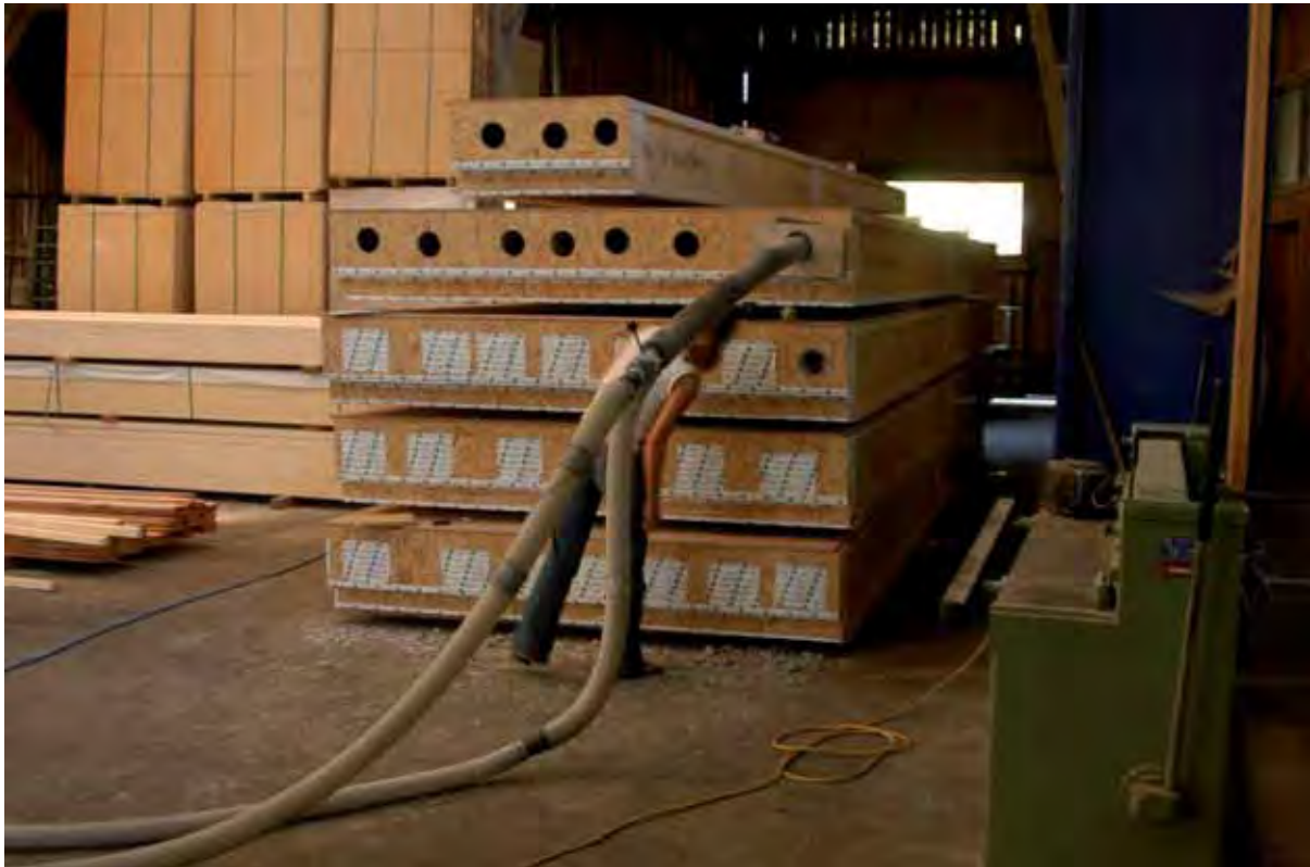
Abb. 17: Das Einblasen der Zellulosedämmung
