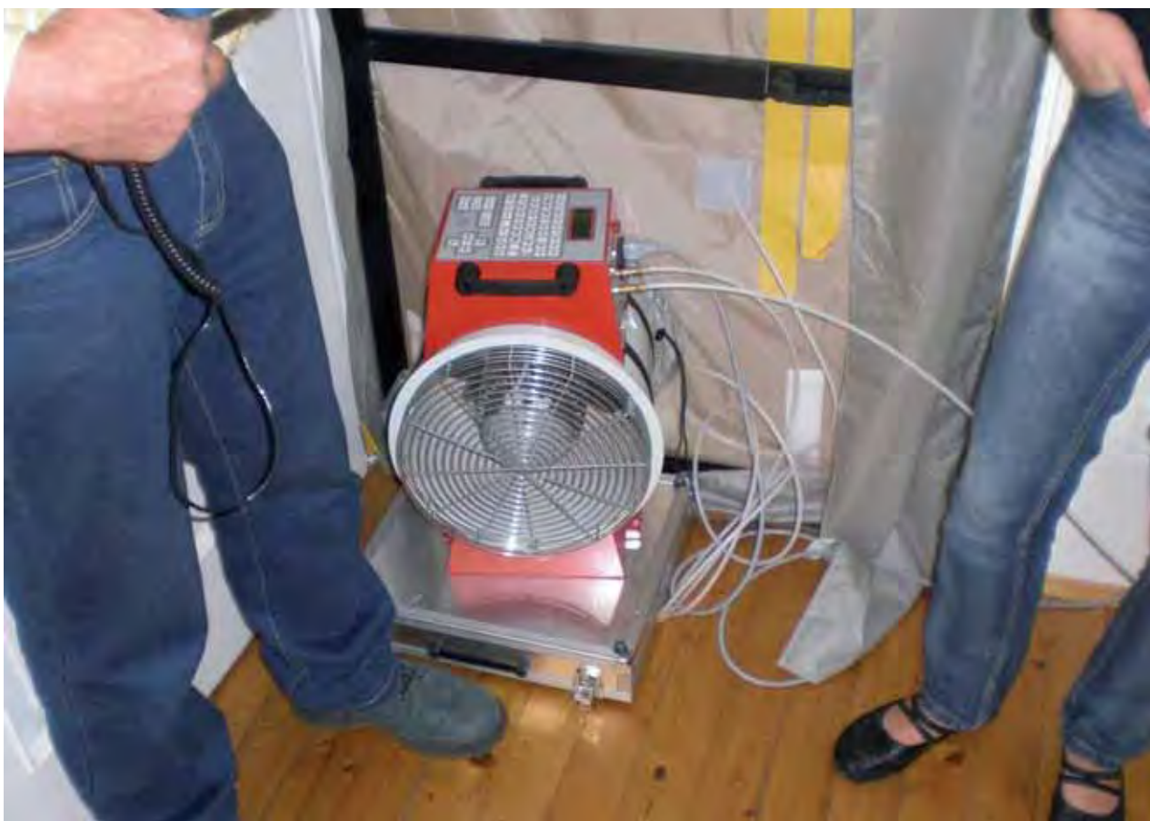
Abb. 19: Vorbereitung des Differenzdruckaufbaus
