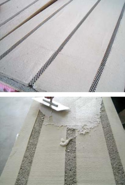
Probekörper mit unterschiedlicher Schlitzausführung
