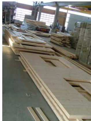
01.02.2006: KLH-Platten vorbereitet zur Fertigung
