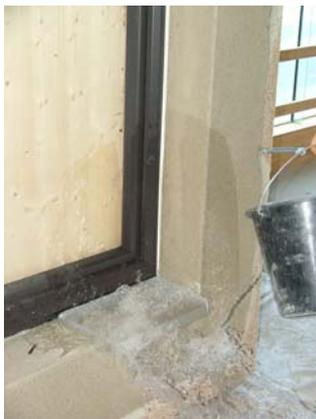
01.02.2006: Musterfertigteile: Prüfung „Schlagregendichtheit“
