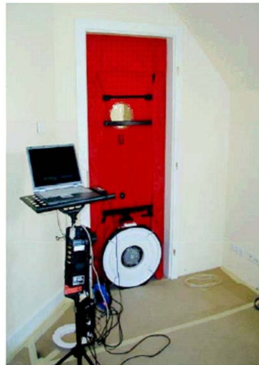
Bild 3: Aufbauten eines Blower Door Tests (arsenal research)
