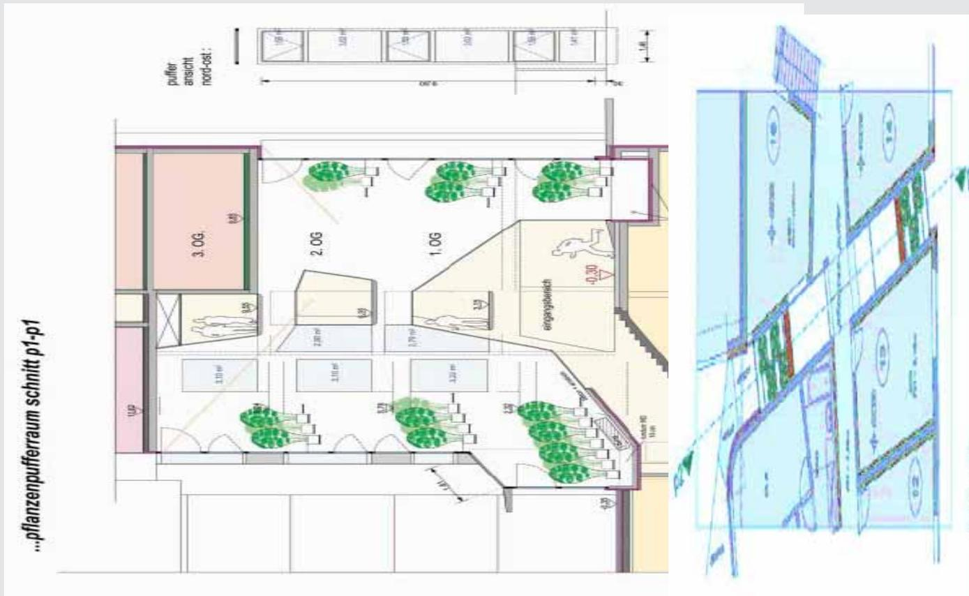
Der Pflanzenpufferraum ist jetzt als 9 – 12 m hoher und 1,7 m schmaler Schlitz quer durch das Gebäude konzipiert, er hat ca. 200 m<sup>3</sup> und wird in der Mitte von den Erschließungsgängen wie von 2 verglasten Röhren durchstochen.
