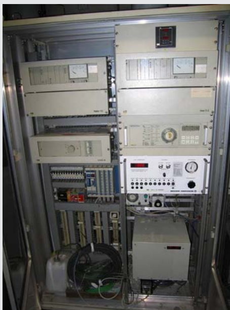
Bild: Abgasmessschrank (links) und qualitativer Emissionsverlauf in einem Taktzyklus eines Biomassekessels (rechts) [IWT]
