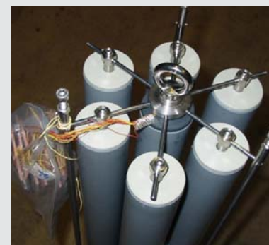
Bild: Wärmespeicherfähigkeit verschiedener Stoffe im Vergleich zu Wasser (links) und PCM Speichermodule (rechts) [IWT]
