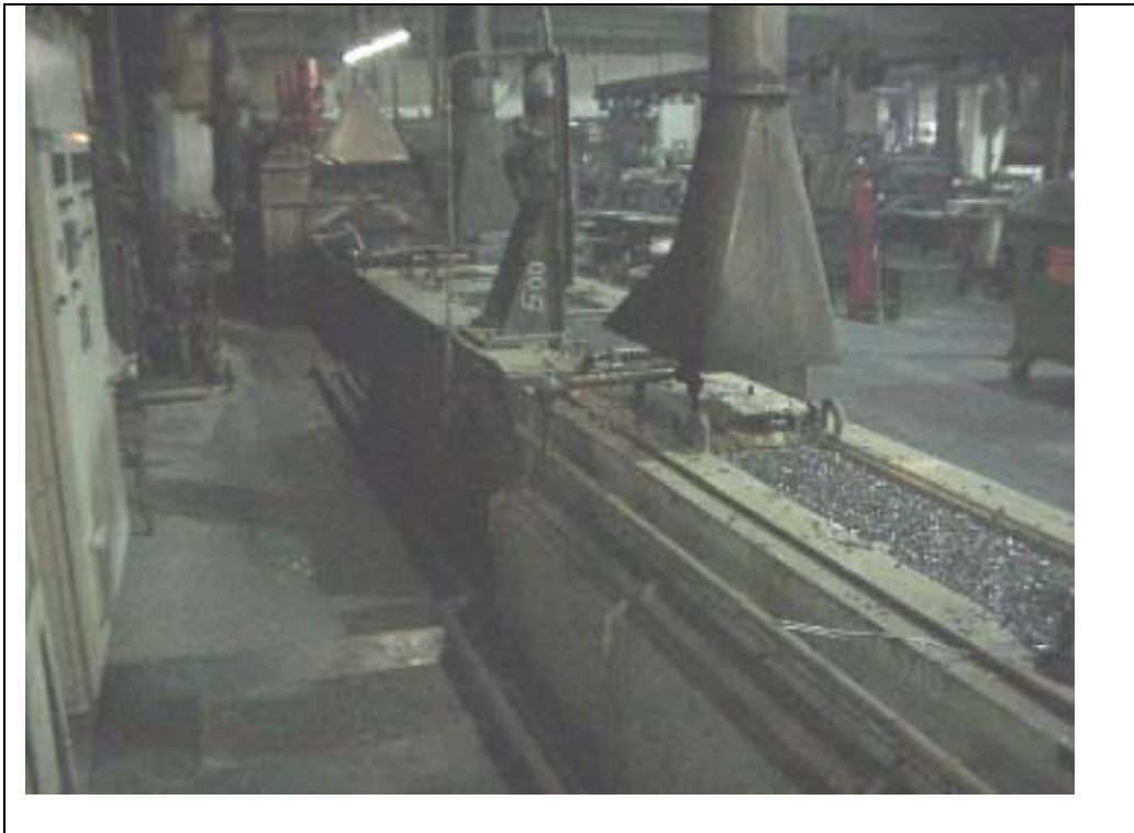
Abbildung 4-3: Anlage Ölvergüten VII, Austritt aus dem Ofen, Ölbad und zwei Bleibäder
