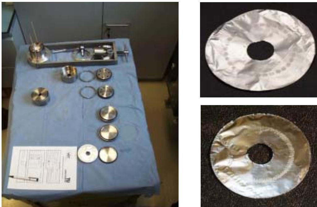
**Abbildung 8: Zerlegter Kaskadenimpaktor (links) und zwei Folien mit abgeschiedenen KSS (rechts)**
