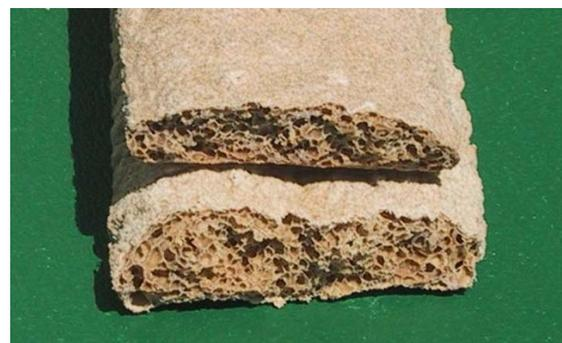
nach einem Schneckentausch (Schnecke mit höherer Scherwirkung) war eine hohe Expansion zu beobachten, die Oberfläche blieb jedoch unregelmäßig.
