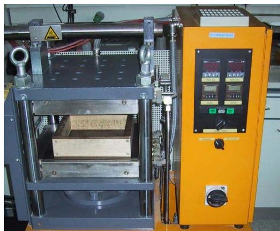
Das Schaumgranulat wurde vorgeheizt und zuerst in der kalten Form gepresst, dann wird eine Temperatur von  $T=150-200^{\circ}\text{C}$  für 15 min gehalten; zuerst wurde ohne Kleber gepresst, die Klebrigkeit wurde nur durch Besprühen mit Wasser erhalten.
