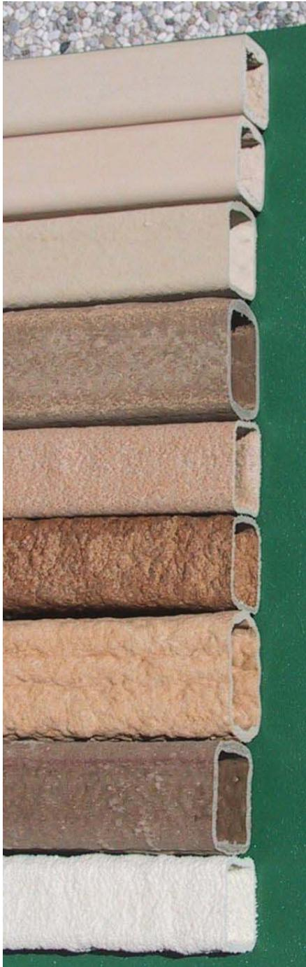
Bei der Profilextrusion konnten Dichten von 0,76 – 0,86 g/cm<sup>3</sup> erreicht werden.
