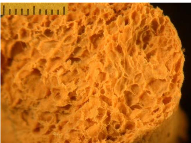
Die Skala an der linken oberen Ecke jedes Bildes dient zu Bestimmung der Porendurchmesser. Die kleinen Teilstriche haben einen Abstand von 200  $\mu\text{m}$ , die großen von 1 mm.
