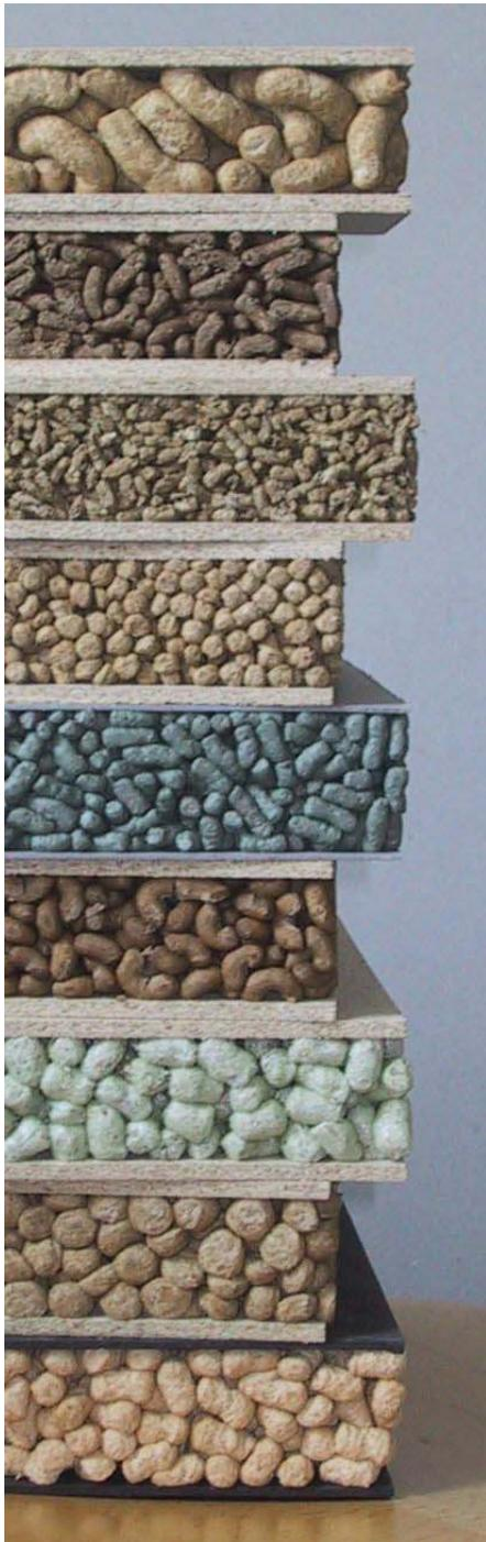
Es wurden unterschiedliche Schüttkörper verpresst, deren Schüttdichte durch die verschiedenen Ausformungen beeinflusst wurde. Diese reichten von kugel- bis zylinderförmig.
