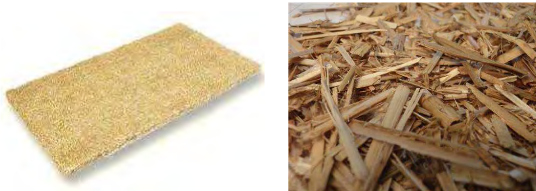
Abbildung 16: Links: Schilfgranulatplatte 34 , rechts: Schilfhäcksel im Detail
