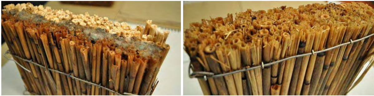
Abbildung 43: Veränderung der Schilfrohre und Schimmelbildung bei langfristig eingetauchten Probekörpern (nach Beendigung des Versuches; Links: Probe 1 - teilweises Eintauchen. Rechts: Probe 2 – vollständiges Eintauchen)
