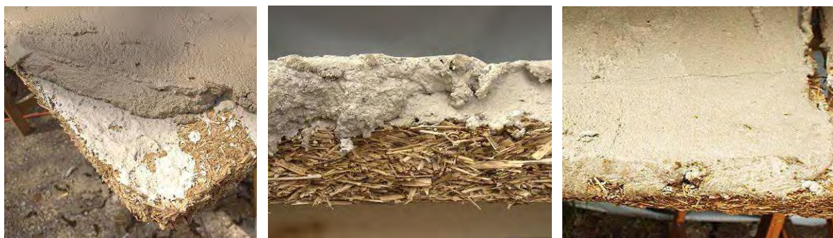
Abbildung 116: Links: Prototyp während des Putzauftrags – Spritzbewurf sowie Grundputz sind sichtbar. Mitte: Seitenansicht der ausgehärteten Platte vor dem Zuschnitt. Rechts: ausgehärtete Oberfläche mit leichten Rissen
