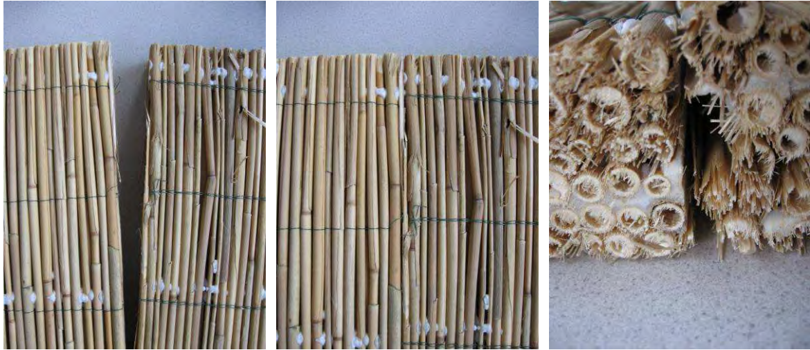
Abbildung 64: Kantengenauigkeit zwischen zwei thermoplastgebundenen Platten
