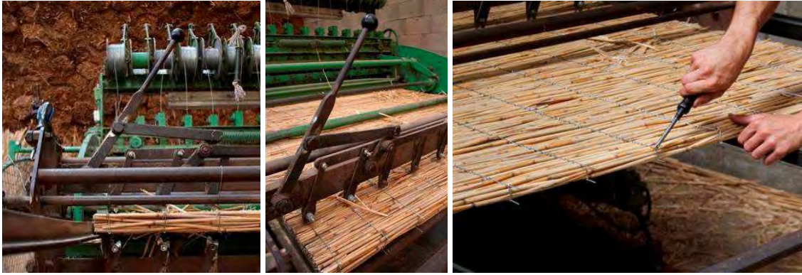
Abbildung 14: Maschinelles Binden. Abklemmen und Umbiegen der Führungsdrähte erfolgt manuell
