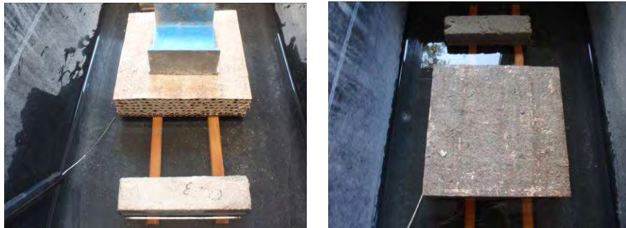
Abbildung 48: Wasseraufnahme von P.6 (Stärke). Links: zu Beginn; rechts: nach 24 Stunden
