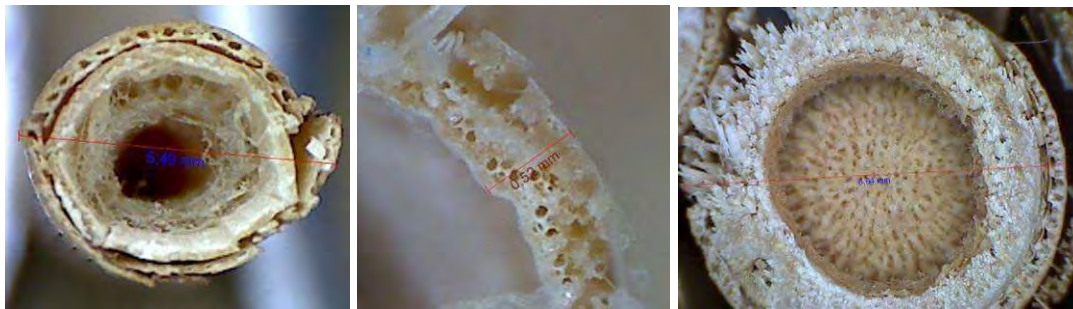
Abbildung 5: Mikroskopaufnahmen eines Schilfhalmes. Links: Halmquerschnitt mit Blatt. Mitte: Halmquerschnitt. Rechts: Halmquerschnitt mit sichtbarem Diaphragma.
