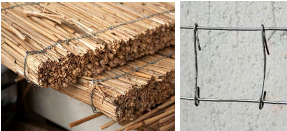
Abbildung 15: Links: Schilfrohrplatten mit Drahtbindung; rechts: Führungsdrähte und Abbindedrähte
