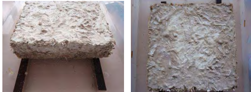
Abbildung 46: Wasseraufnahme von P.4 (Wärmedämmender Leichtputz). Links: direkt nach dem Eintauchen. Rechts: Wasseraufnahme bis zum oberen Rand
