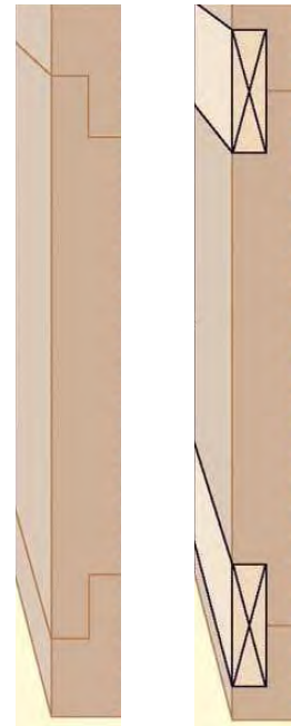
Abbildung 66: Stufenfalzplatten. Links: vollflächige Verlegung; rechts: Verlegung mit Montageleisten 51
