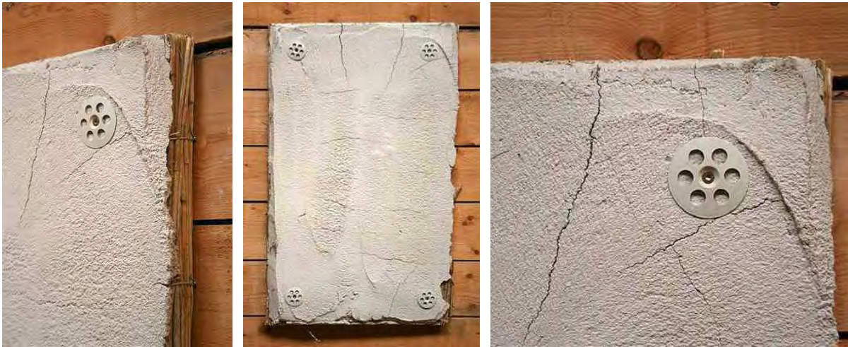
Abbildung 114: Prototyp aus drahtgebundener Schilfrohrplatte und Kalkputzbeschichtung nach Befestigung mit sichtbaren Rissen an den Druckstellen
