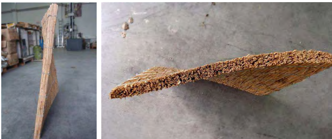
Abbildung 58: Flexibilität der drahtgebundenen Schilfrohrplatte
