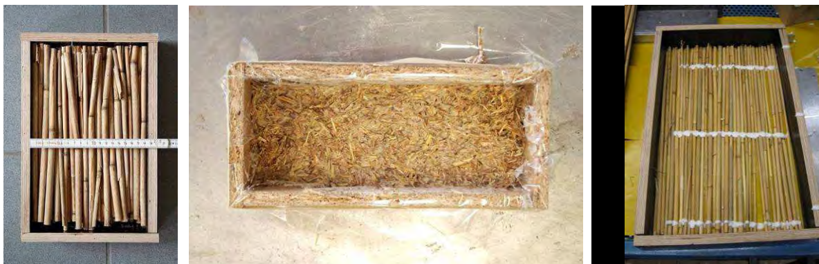
Abbildung 21: Links: Probekörperform; Mitte: Verfüllung einer Kasein-Schilfhäcksel-Masse; rechts: Bahnen von geschäumtem Heißkleber auf Schilfrohren
