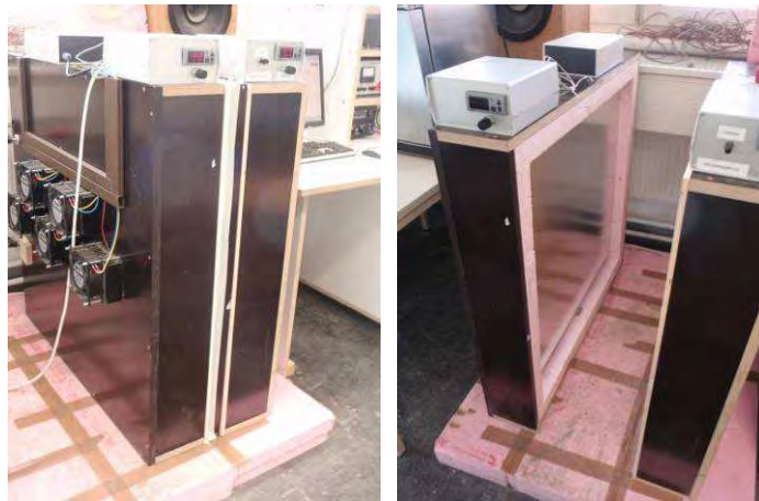
Abbildung 41: Links: Heizkasten im Betrieb mit eingespannter Probe und Abluftelemente auf der Kaltseite. Rechts: Luftleitblech auf der Kaltseite
