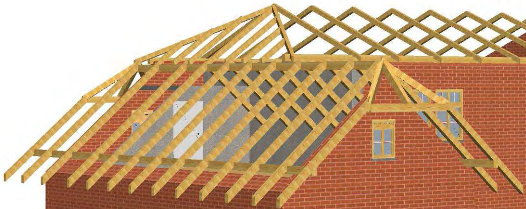
Abbildung 138: Darstellung der Dachkonstruktion des Nebentrakts
