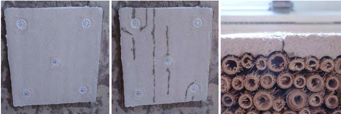
Abbildung 123: Anbringung thermoplastgebundene Schilfrohrplatte. Links: Befestigung. Mitte: Haarrisse sichtbar gemacht. Rechts: Bruch.
