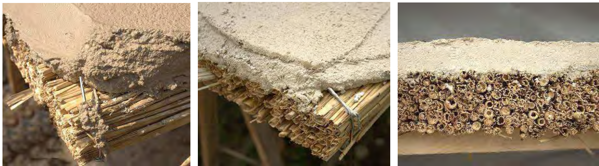
Abbildung 113: Links: Prototyp während des Putzauftrags. Mitte: Prototyp nach der Aushärtung. Rechts: Seitenansicht der ausgehärteten Platte vor dem Zuschnitt
