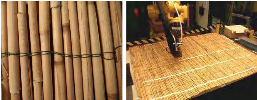
Abbildung 39: Links: Schilfmatten, mit Polyamidschnüren gebunden; rechts: Aufbringen der Klebebahnen mittels Roboterarm
