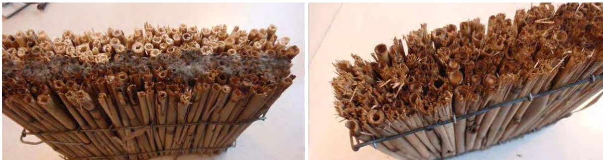
Abbildung 44: Probekörper nach Rücktrocknung bei Raumtemperatur. Links: Probe 1 – teilweise eingetaucht. Rechts: Probe 2 – vollständig eingetaucht)
