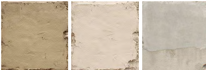
Abbildungen 94: NHL 3,5 BSM. Links: Grundputzauftrag. Mitte: Grundputz erhärtet. Rechts: Feinputzauftrag
