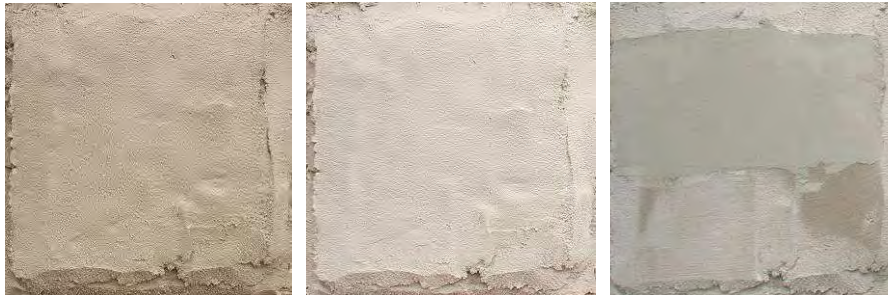
Abbildungen 91: Thermoputz NHL 3,5. Links: Grundputzauftrag. Mitte: Grundputz erhärtet. Rechts: Feinputzauftrag
