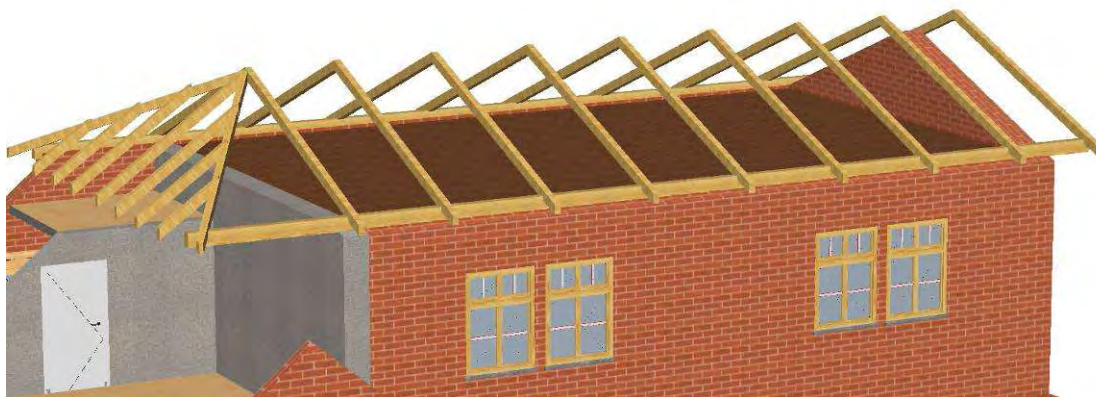
Abbildung 136: Darstellung der obersten Dachkonstruktion (ohne Mansarddachelemente)
