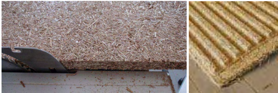
Abbildung 18: Schilfgranulatplatte ohne und mit Rillensystem 35
