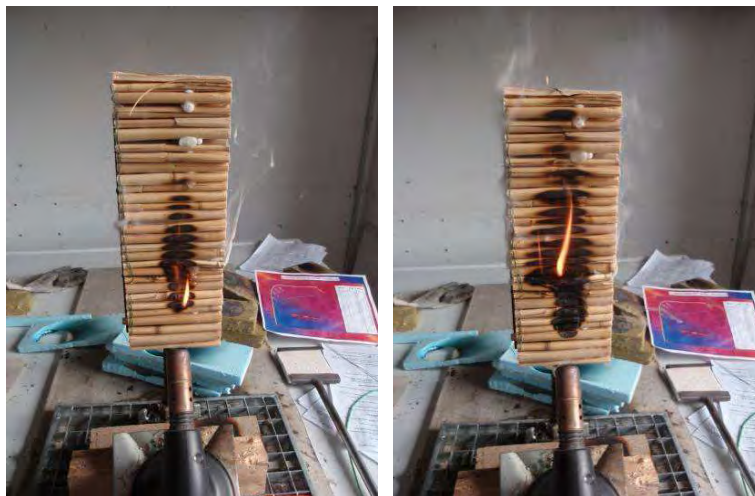
Abbildung 53: Brandverhalten von Schilfrohren mit aufgeschäumtem Thermoplast als Bindemittel. Links: nach 15 s. Rechts: nach 60 s
