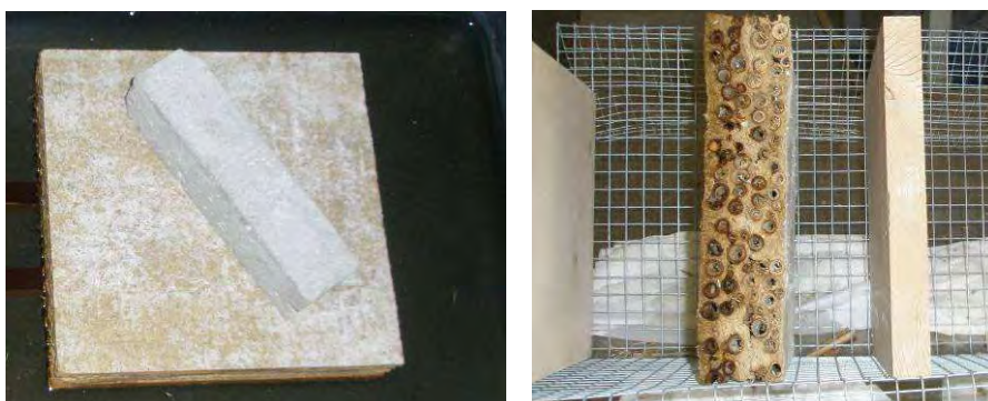
Abbildung 47: Wasseraufnahme von P.5 (Kasein). Links: während des Versuches. Rechts: nach dem Versuch auf dem Trocknungsständer im Winkel von 45°
