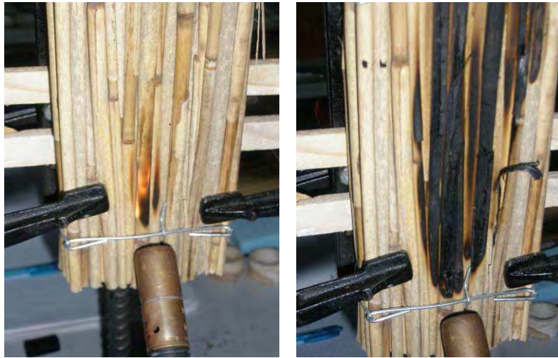
Abbildung 49: Brandverhalten der drahtgebundenen Schilfrohrplatte. Links: nach 15 s. Rechts: nach 60 s
