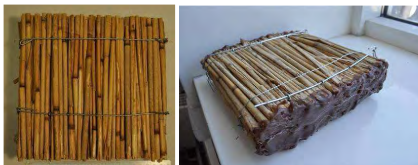
Abbildung 42: Links: Schilfrohrprobe mit offenen Enden. Rechts: Probe mit abgeklebten Enden
