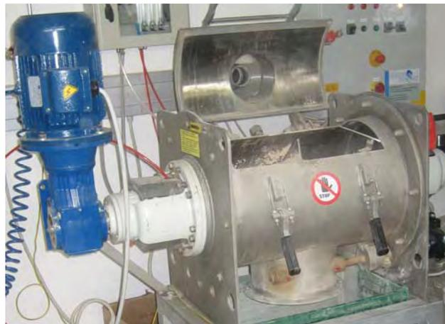
Abbildung 7 Pflugscharmischer für Mischversuche an der FH Salzburg
