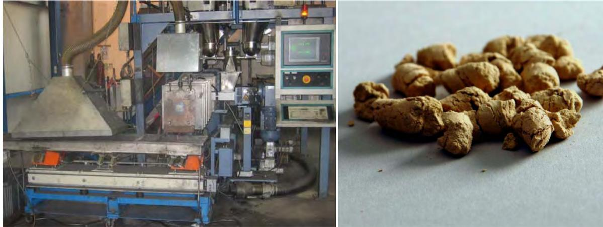
Abbildung 11 Doppelschneckenextruder des Unternehmens SGL Carbon und hergestelltes Granulat
