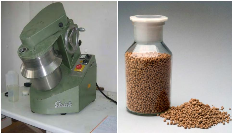
Abbildung 10 Eirichmischer und hergestelltes Granulat des Telleragglomerators
