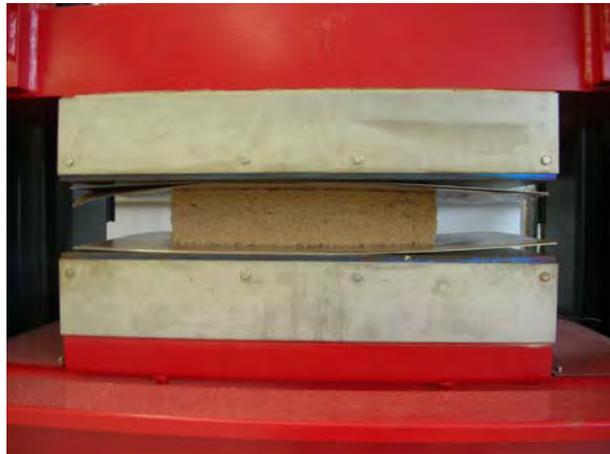
Abbildung 8 Presskuchen in einem Rahmen aus Holzweichfaserplatten bei der Pressung an der FH Salzburg
