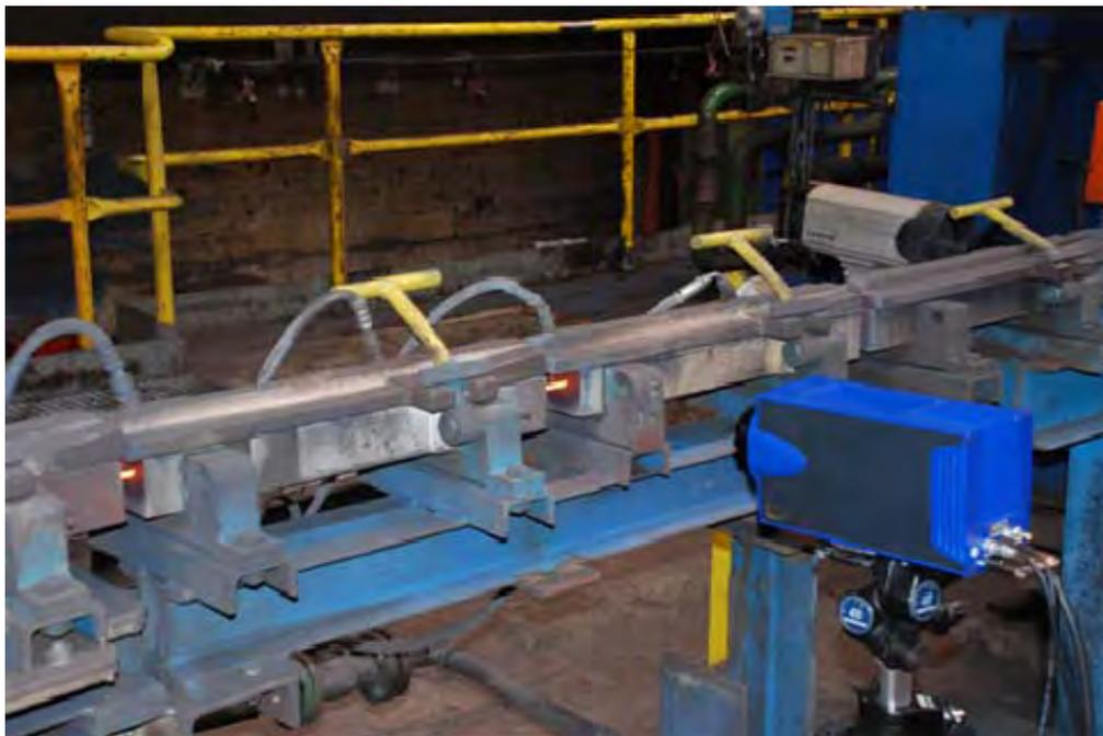
**Abbildung 35: Position der Infrarot-Kamera**
