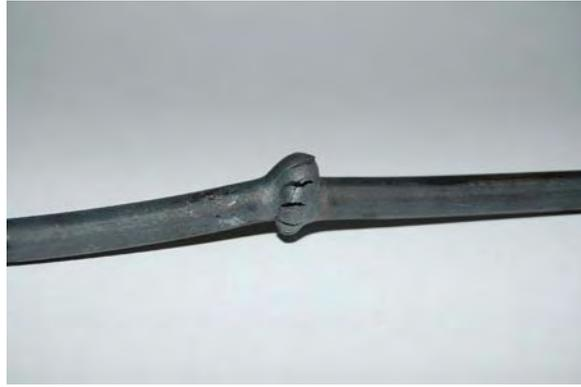
**Abbildung 4: Gestauchtes Drahtstück mit aufgeplatzten Rissen**
