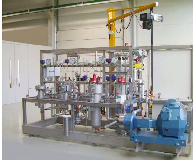
Abbildung 24: CO 2 – Forschungsextraktionsanlage 5l/1000 bar der Firma Natex (Mit freundlicher Genehmigung der Natex GmbH)
