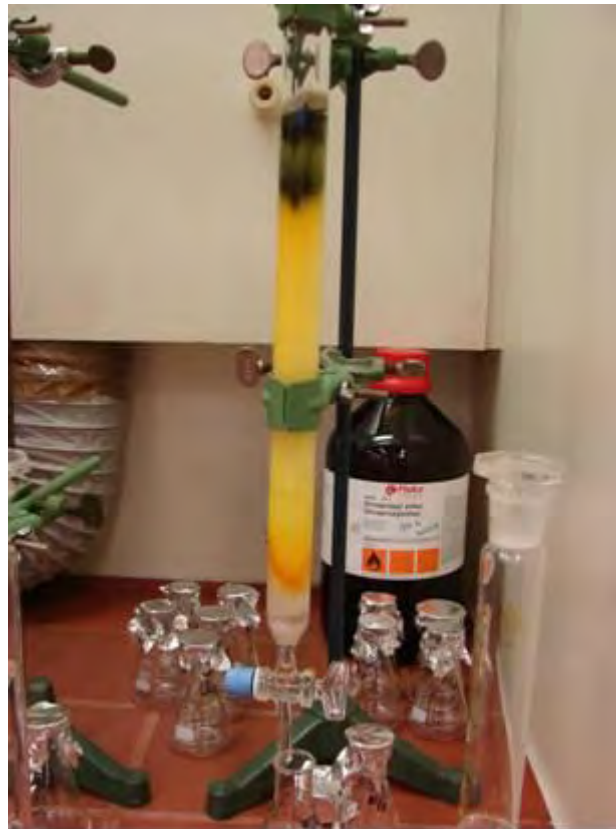
Abbildung 5: Fraktionierung des Rainfarnextrakts im Milligrammbereich
