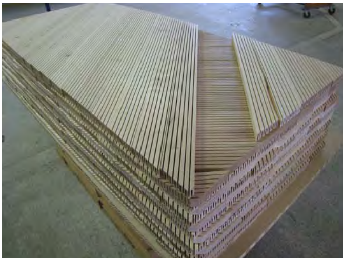
Abbildung 6 Links: Kernschichten der DendroLight Platten (Leichtbau-Massivholzplatte) hergestellt aus Laubschwachholz. Rechts: Hocker „Augustin“ hergestellt aus Laubschwachholz durch die Tischlerei Fuchs in Wien
