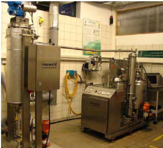
Abbildung 4.2- 4: Extraktionsanlage inkl. Dünnschichtverdampfer (JR)
