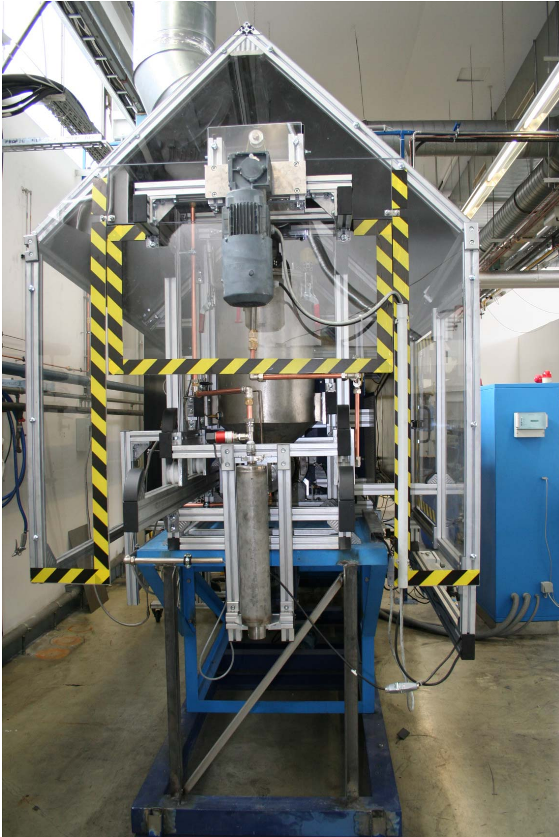
Katalysator-Vorratsbehälter mit außenliegendem Rührwerksantrieb
