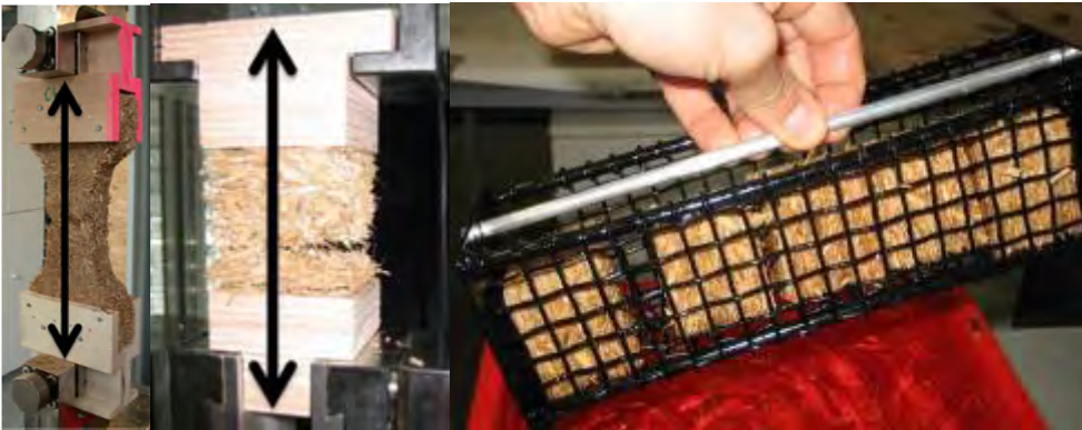
Abbildung 4: Prüfung von Typha-Dämmstoffplatten unter dafür adaptierten Bedingungen. links: Längszugfestigkeit, Mitte: Querkzugfestigkeit, rechts: Dickenquellung nach 24 Stunden Wasserlagerung
