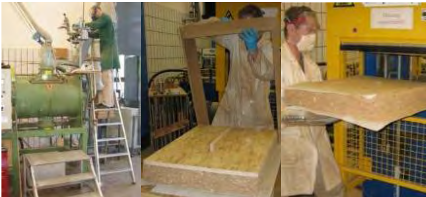
Abbildung 3: Laborplattenproduktion an der Universität Hamburg. links: Mischer, Mitte: händisch gestreute und vorverdichtete Partikelmatte, rechts: Heißpresse
