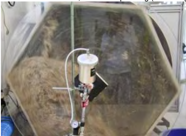
Abbildung 6: Neu konstruiertes Beleimsystem bestehend aus einer sechseckigen Trommel mit Sichtfenster, regelbarem Antrieb (nicht sichtbar) und fein justierbarer Leimapplikation (im Vordergrund).
