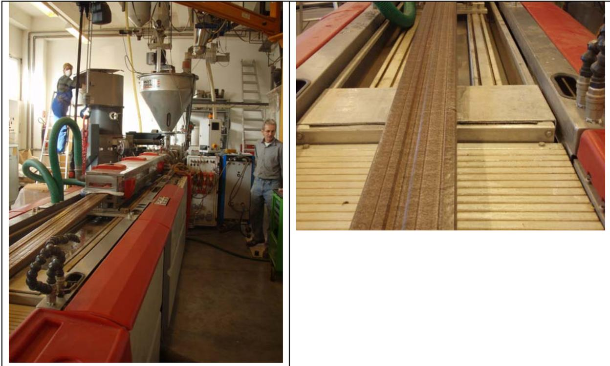
*Abb. 66: Profilextrusion mit dem Schneidverdichter und durch Direktextrusion hergestelltes Profil*
