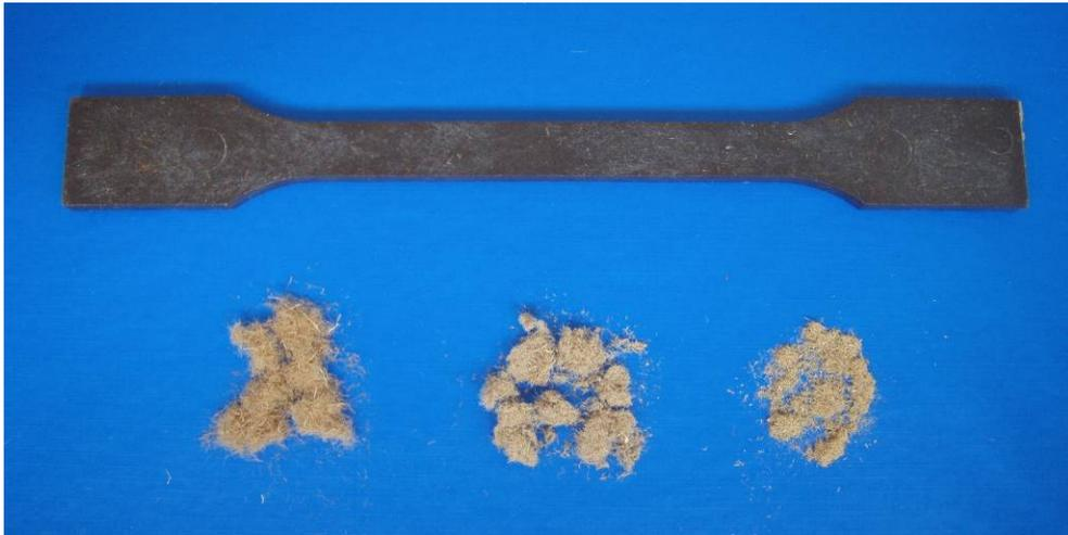
*Abb. 58: Faserlängenabbau Compounder, RF- kurz; Prozessschritte von links: Rohfaser, Pellet, Spritzguss;*
