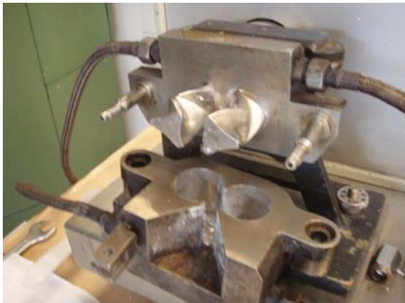
Abb. 28: Knetter mit geöffneter Knetkammer
