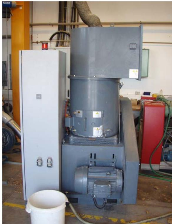
Abb. 65: Schneidverdichter
