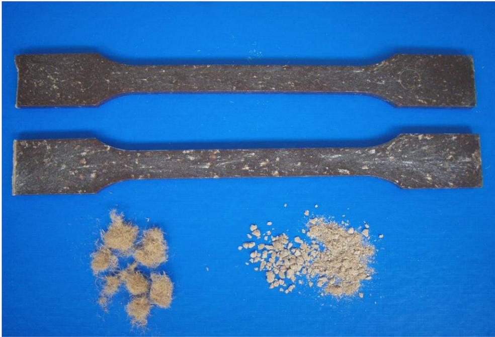
*Abb. 62: Faserlängenabbau Schneidverdichter; RF- kurz; links: Rohfaser, rechts: Spritzguss mit zum Teil agglomerierten Fasern; Prüfkörper oben: Fasern nicht agglomeriert, Prüfkörper unten: Fasern agglomeriert*
