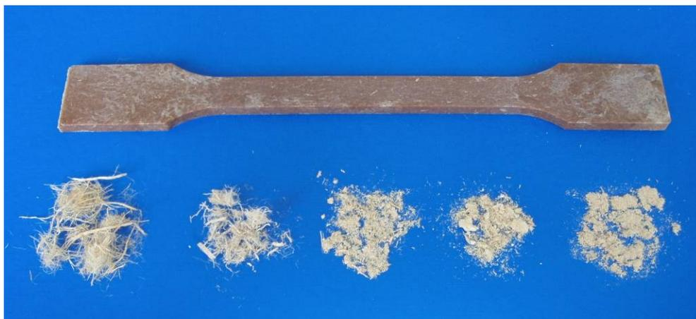
Abb. 56: Faserlängenabbau Compounder, RF- lang; von links: Rohfaser, Pellet, Strang, Granulat, Spritzguss; oben: Spritzguss- Prüfkörper
