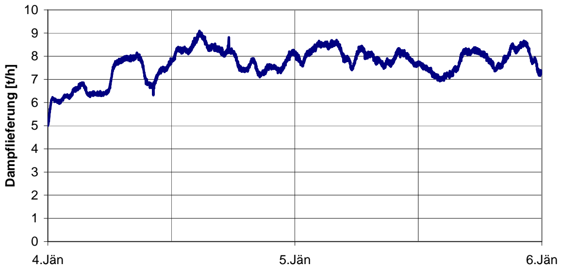
Abbildung 16: Dampflieferung aus der Schienenkühlung eines Hubbalkenofens in der Stahlindustrie
