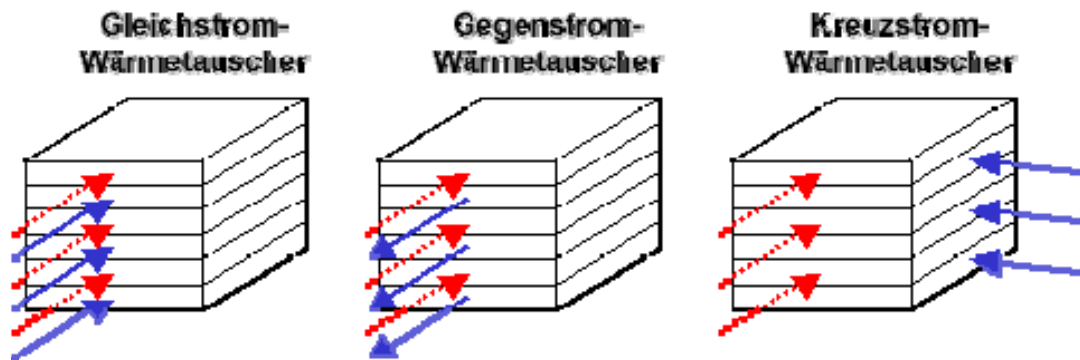
Abbildung 29: Schematische Darstellung der verschiedenen Fluidführungen bei Wärmetauschern
