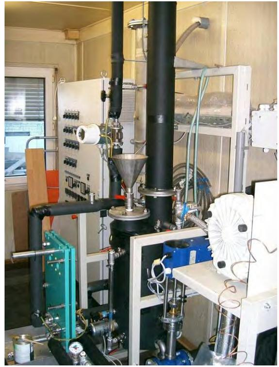
**Abbildung 11b: Detail der ES-KRA-MAFI in Edelstahl: Links Stufe 2 instrumentierter Wäschertank mit Einrichtungen, rechts Stufe 3, sowie Steuerschrank.**
