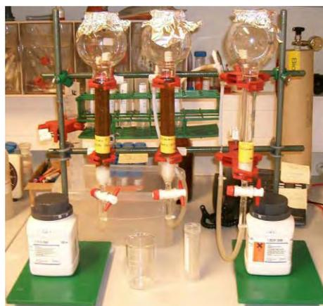
**Abbildung 13: Trennmethode durch Säulen: Aktivkohle und Ionenaustauscher.**
