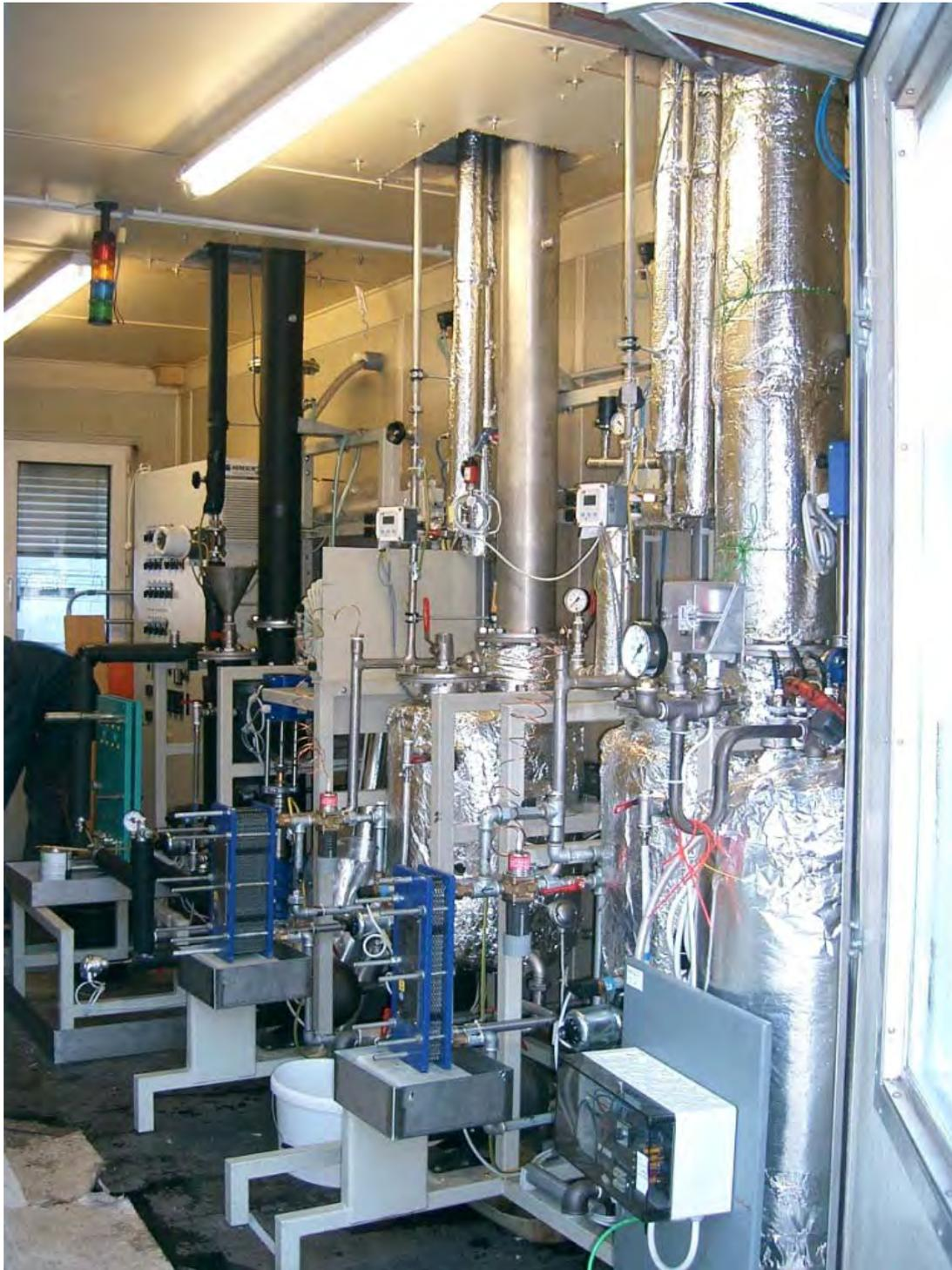
**Abbildung 11a: Endausbau der Rückkondensationsanlage ES-KRA-MAFI in Edelstahl: rechts Stufe 1, Mitte Stufe 2 und links Stufe 3, sowie Steuerschrank.**
