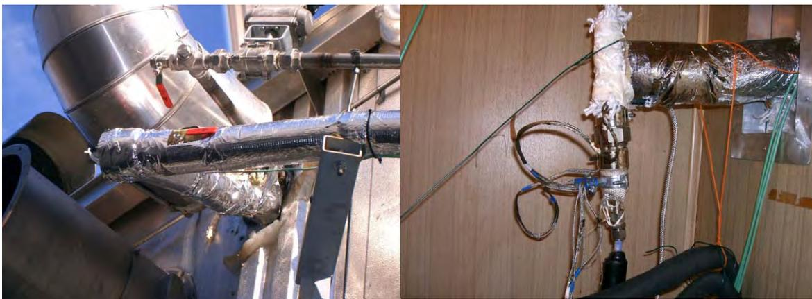
**Abbildung 6: Leitungsführung Container – Zuleitung zur Beprobung (Labscale). Oben links: Entnahmestelle Thermokammer; rechts: Anschlussstelle Container; errichtet durch die Fa. Putz.**
